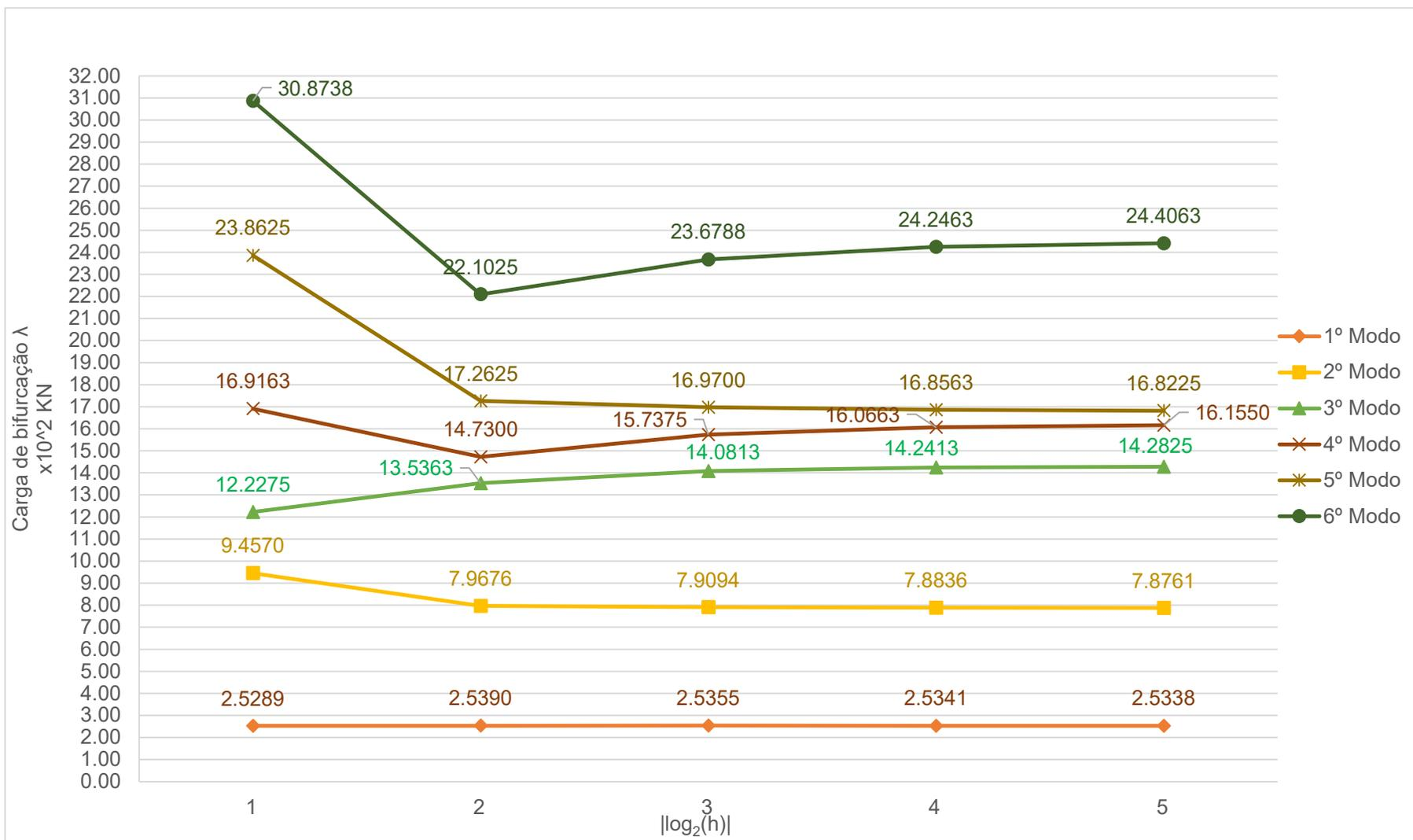
Figura 39- Gráfico das cargas de bifurcação da placa da Figura 38 em função da dimensão  $h$  dos elementos finitos (elemento finito ACM).
