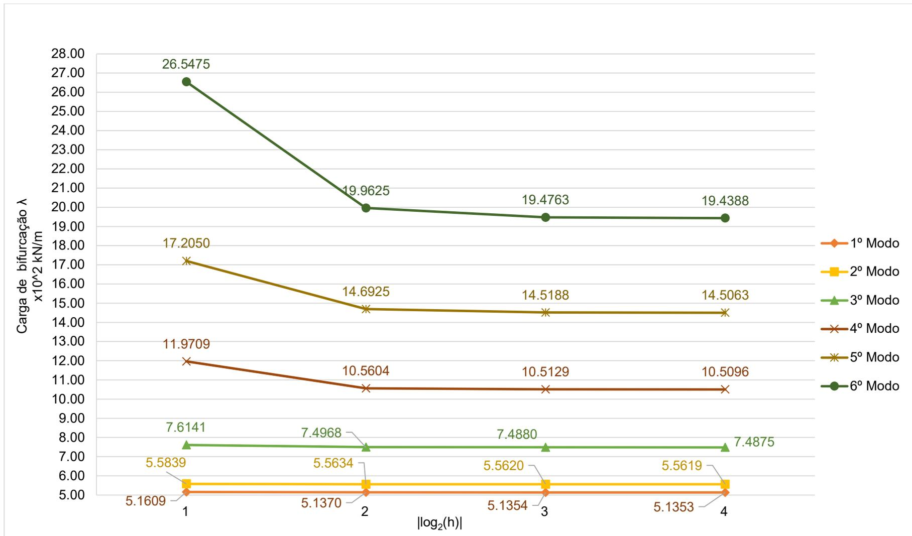
Figura 13- Gráfico das cargas de bifurcação da placa da Figura 8 em função da dimensão  $h$  dos elementos finitos (elemento finito BFS).
