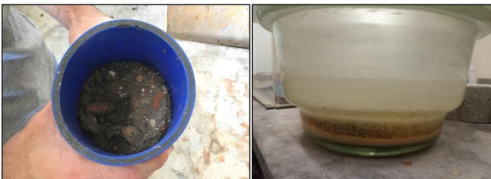
*Figura 37 - Problemas de estabilidade da matriz do betão produzido com AR e CFRSU (esquerda) e perda de massa dos provetes (assente no fundo) após 24 h na máquina de vácuo (direita)*
