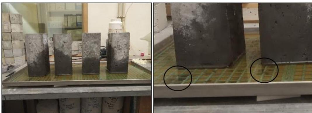
Figura 35 - Fenómeno da perda de massa nos provetes durante ensaio da absorção de água por capilaridade
