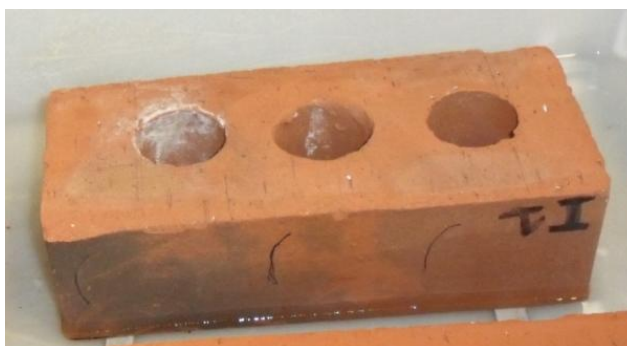
Figura 6.28 - Presença de sais à superfície do tijolo Inglês. Ensaio de absorção de água por capilaridade (direção Z).
