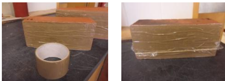
Figura 6.9 - Impermeabilização das faces laterais dos tijolos inteiros.
