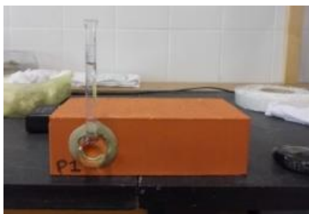
Figura 6.3 - Ensaio de absorção de água sob baixa pressão.
