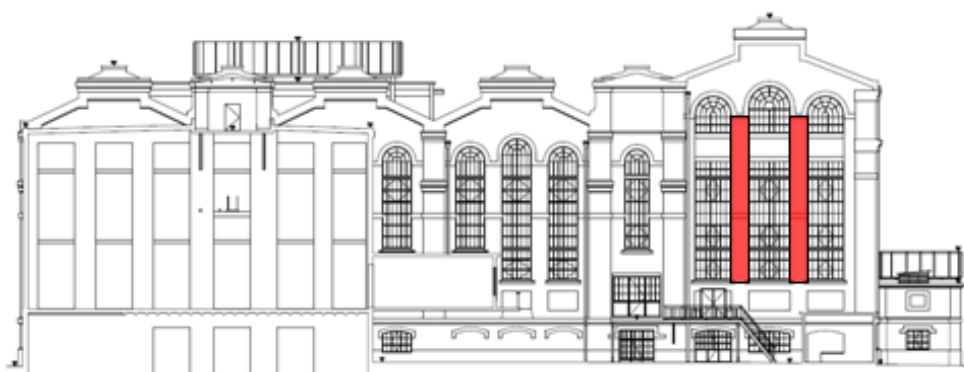
Figura 5.22 – Localização dos panos de alvenaria reconstruídos na fachada Poente da BP.
