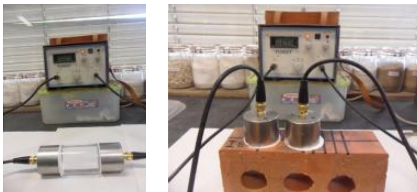
Figura 6.11 - Ensaio de determinação de ultra-sons. Calibração (esquerda) e realização do ensaio (direita).
