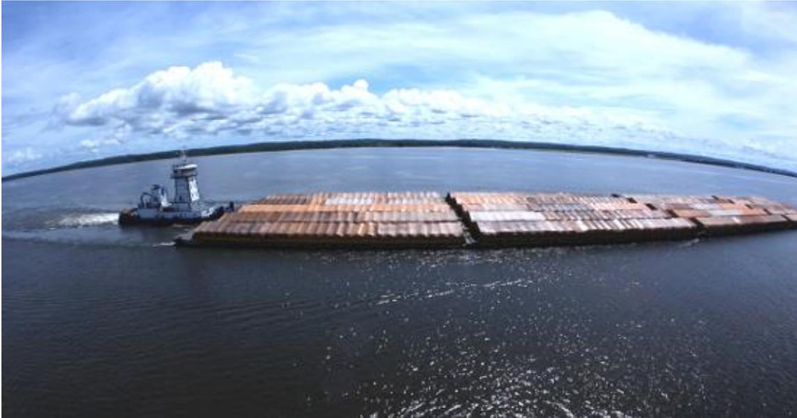
**Figura 4.16: Exemplo de um comboio 5x3 sendo transportado por empurrador.**
