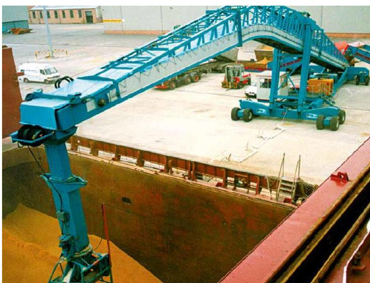
**Figura 4.20: Ship loader em operação.**
