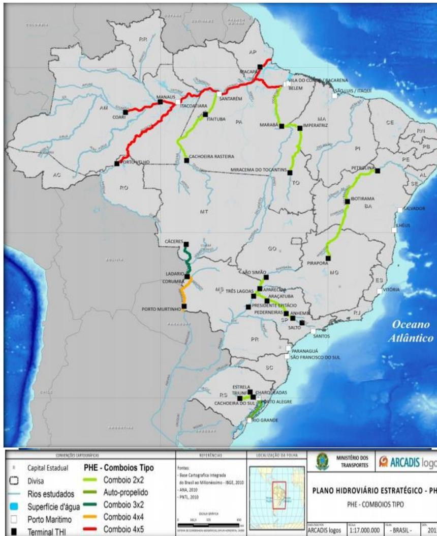
**Figura 6.5: Formação dos comboios recomendado para as hidrovias brasileiras. Indica, por cores, a configuração dos comboios a serem utilizados considerando-se a característica de navegabilidade de cada trecho.**
