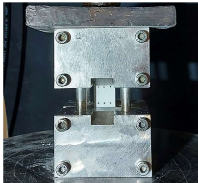
Figura 13 – Ensaio de compressão - imagem real do mecanismo de testagem.
