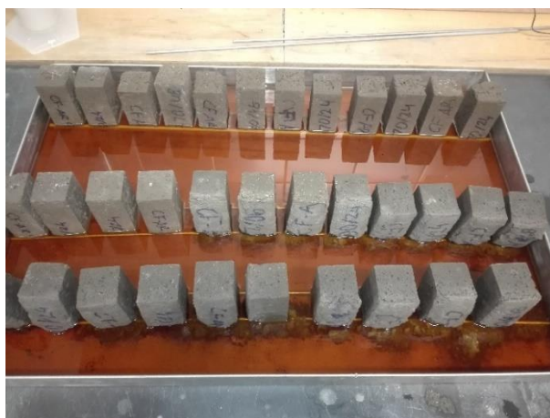
Figura 4.21 Ensaio de absorção de água por capilaridade com as famílias de CF-AN e CF-AR
