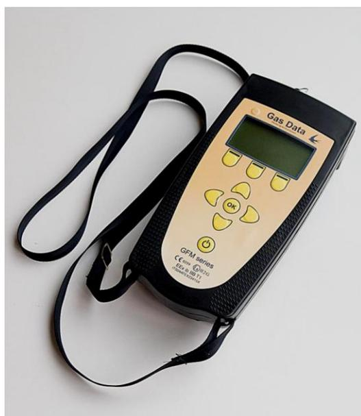
**Figura 3.9** - Analisador portátil multigás modelo GFM130 GASDATA.
