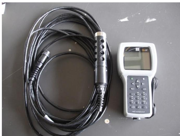
**Figura 3.5** - Sonda de medição multiparamétrica - YSI 556 MPS.
