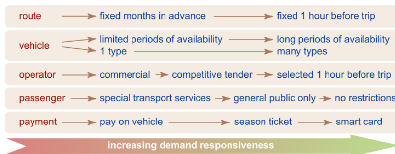
Figura 7 - Variação da flexibilidade ao nível dos componentes. (Brake, Mulley, & Nelson, Good Practice Guide for Demand Responsive Transport Services using Telematics, 2006)
