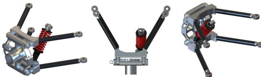
Figura 5.19 – Sistema de suspensão traseiro, em três vistas diferentes.
