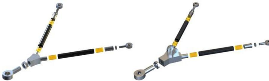
Figura 4.35 – Vista explodida de ambos os braços de suspensão.
