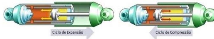
Figura 2.6 - Ciclos de expansão e compressão, adaptado de [11].
