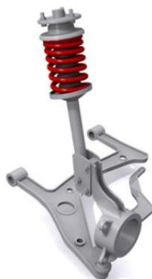
Figura 2.15 - Sistema de Suspensão MacPherson [15].
