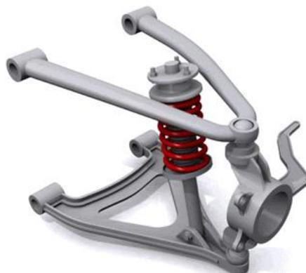
Figura 2.17 - Sistema de Suspensão de Braço Duplo [23].
