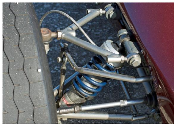
Figura 4.1 – Sistema de suspensão dianteira de braço duplo, num veículo de competição [33].
