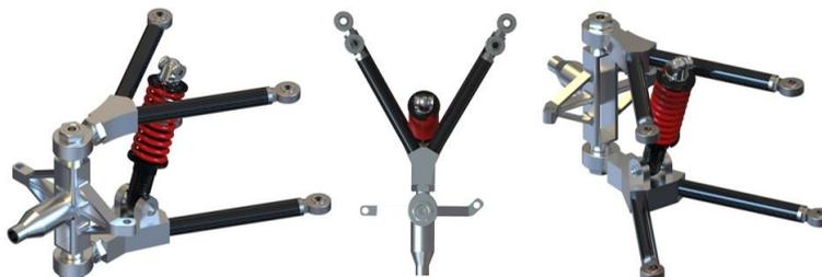
Figura 4.43 – Sistema de suspensão dianteiro, em três vistas diferentes.
