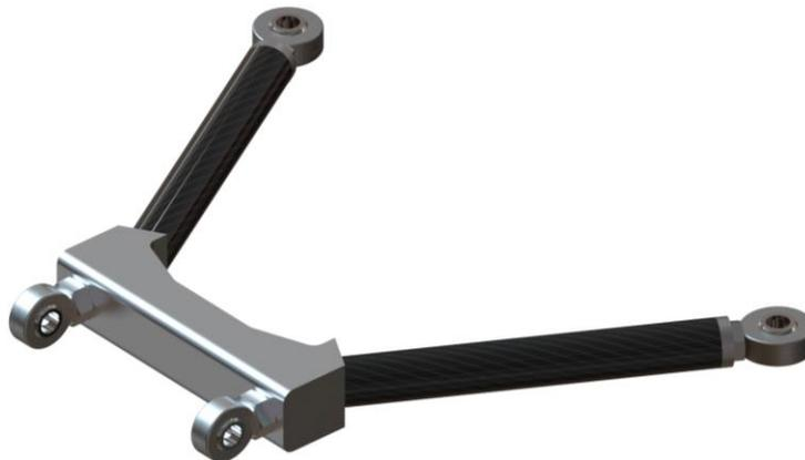
Figura 5.2 – Configuração de um braço superior traseiro.
