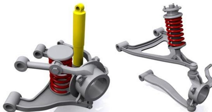
Figura 2.13 - Sistemas de suspensão independentes [23].
