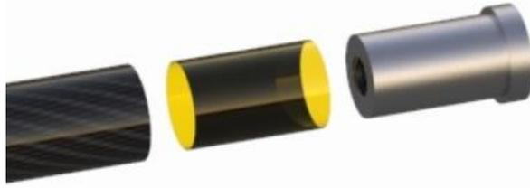
Figura 4.20 – Camada cilíndrica de epóxi, com espessura de 0,2 mm.
