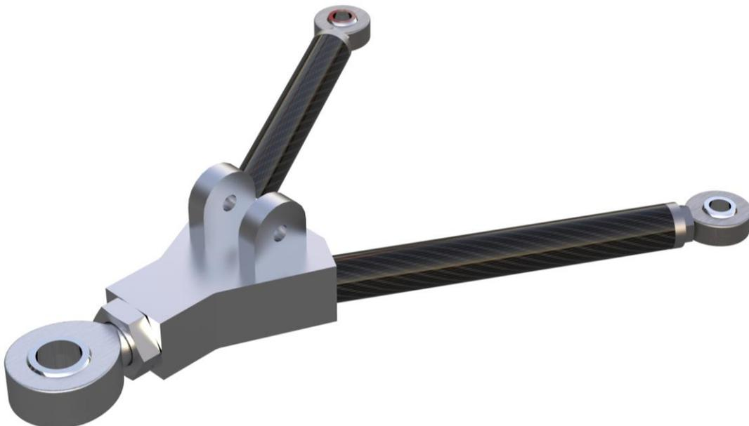
Figura 4.5 – Configuração de um braço inferior dianteiro.
