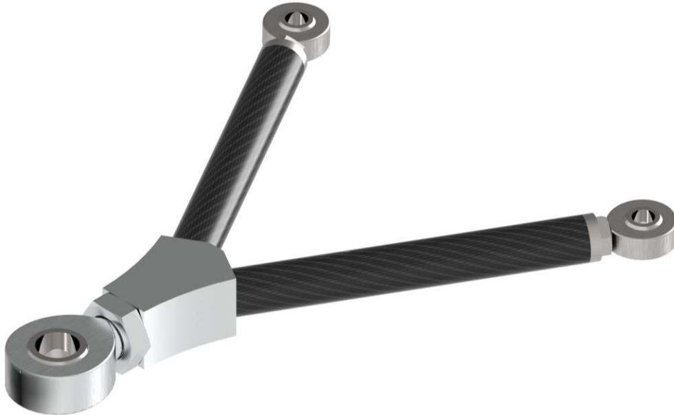
Figura 4.4 – Configuração de um braço superior dianteiro.
