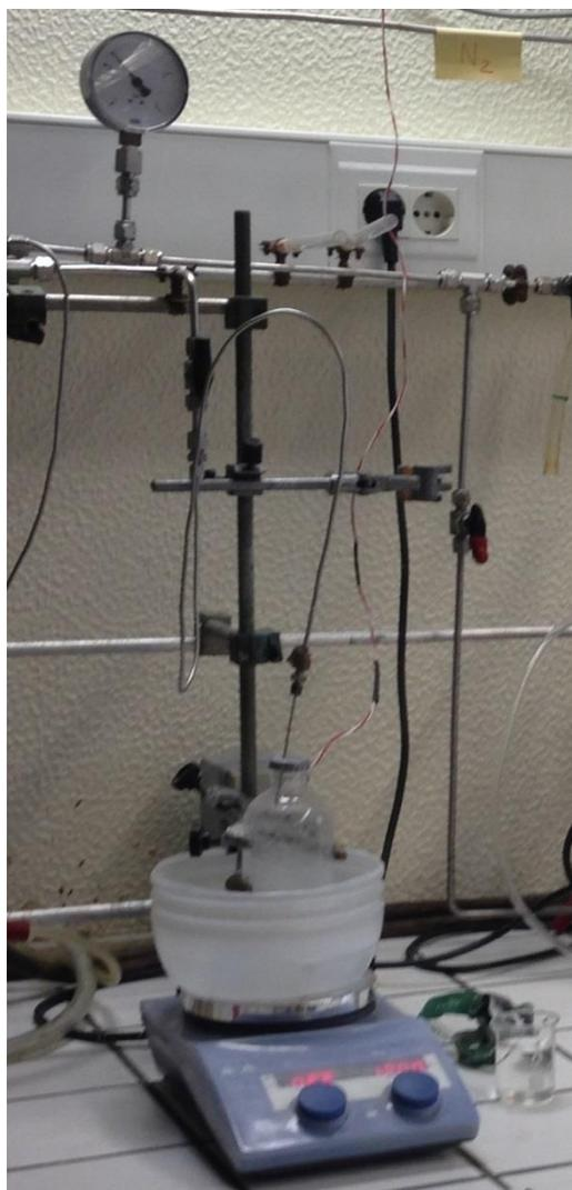
**Figura 12** – Fotografia do reactor utilizado para a polimerização de etileno.
