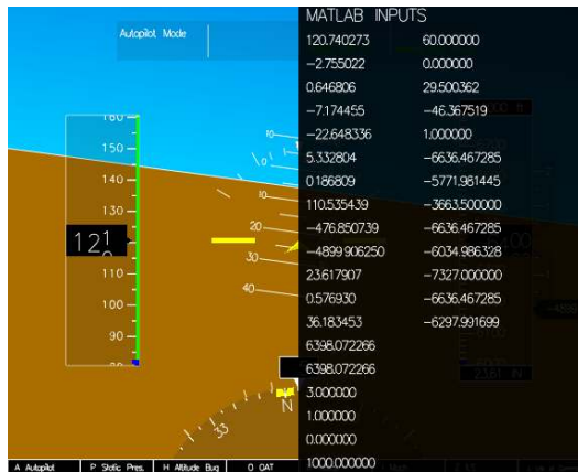
Figura 5.2. Modo de teste do PFD.
