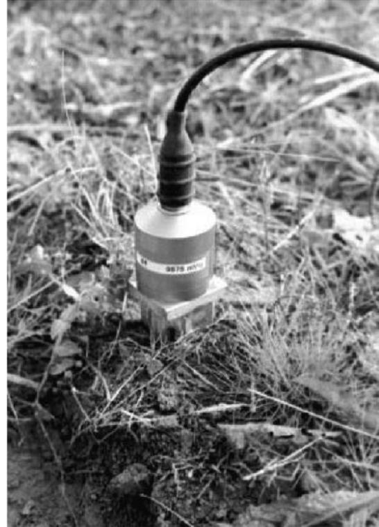
Ilustração 11 - Acelerómetro montado sobre suporte de alumínio do tipo PCB.
