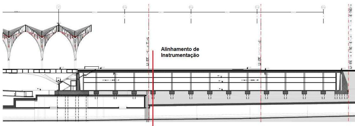
Figura 26 – Alinhamento de instrumentação na estrutura da Gare do Oriente. Geocontrolo (2009).
