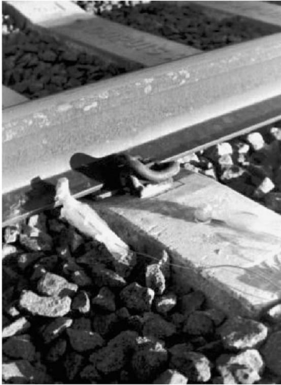
Ilustração 12 - Acelerómetros colocados no carril e na travessa da linha 2 do tipo Dytran.
