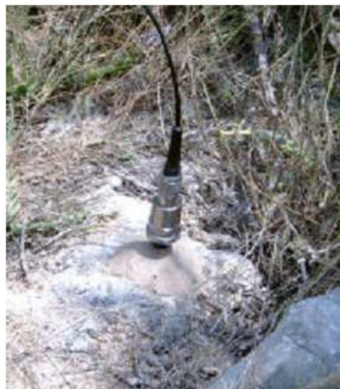
Figura 14 - Acelerómetro montado.
