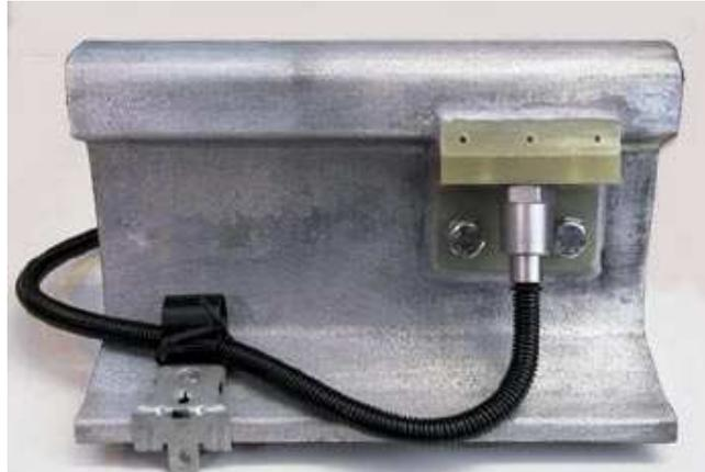
Figura 24 - Fixação para a colocação do acelerómetro no carril. Thrane (2000).
