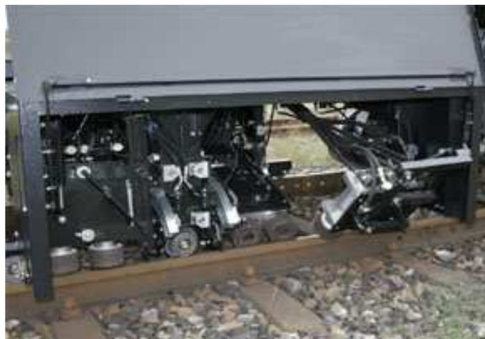
Figura 7 - Manutenção de via: esmerilagem.
