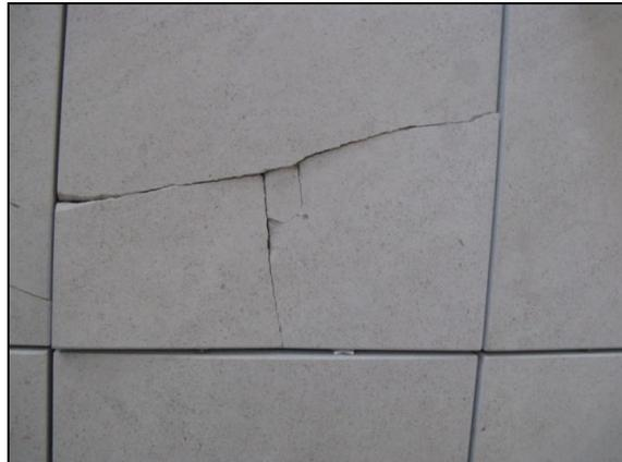
Figura 83 - Quebra de painel devido ao choque de 10 J.
