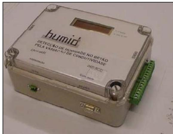
Figura 72 – Humidímetro.
