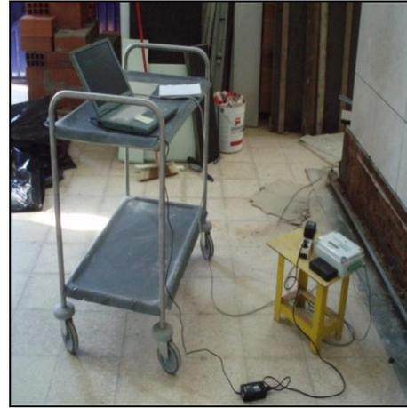
Figura 74 – Humidímetro ligado ao computador.
