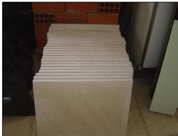
Figura 54 – Pedra moleano para utilização no revestimento da parede.
