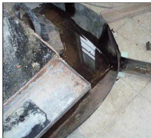
Figura 67 – Pormenor do tapete para reter a água do ensaio.
