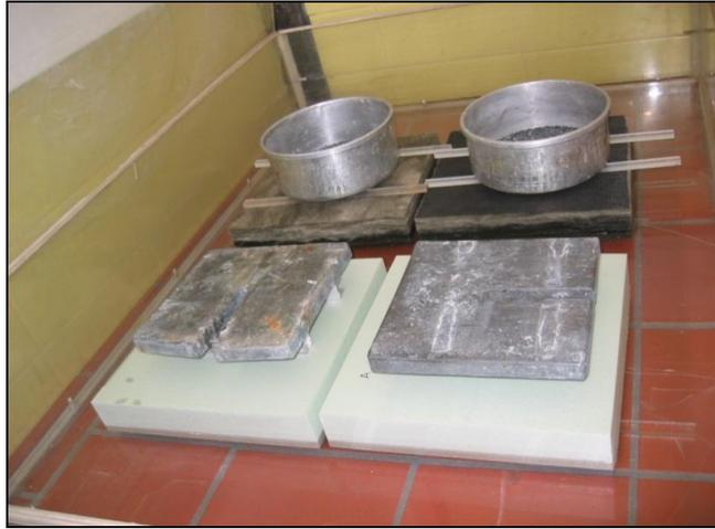
Figura 48 - Provetes na tina com água.
