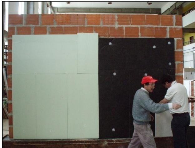
Figura 53 – XPS e Lã de Rocha na parede.
