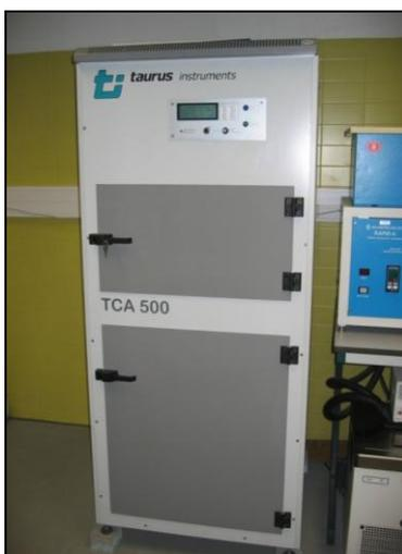
Figura 50 – Equipamento termofluximétrico.
