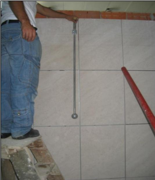
Figura 81 - Aparelho destinado a ensaiar a resistência do revestimento ao choque (ensaio de 10 J).
