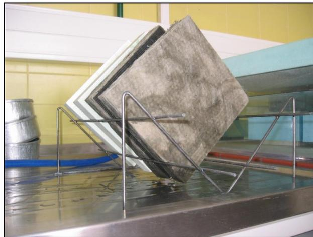
Figura 49 – Secagem dos provetes.
