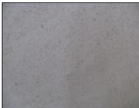
Figura 84 – Danos provocados pelo ensaio de choque de corpo duro de 3 J.
