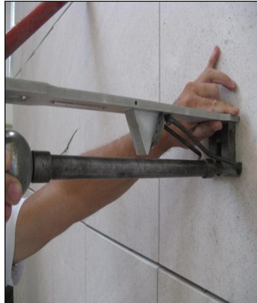
Figura 82 - Aparelho destinado a ensaiar a resistência do revestimento ao choque (Baronnie Martinet) (ensaio de 3 J).
