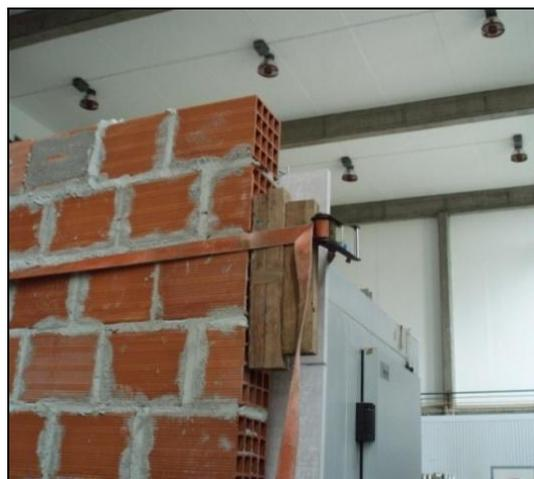
Figura 76 – Tensores a prender a câmara ao sistema de fachada ventilada.
