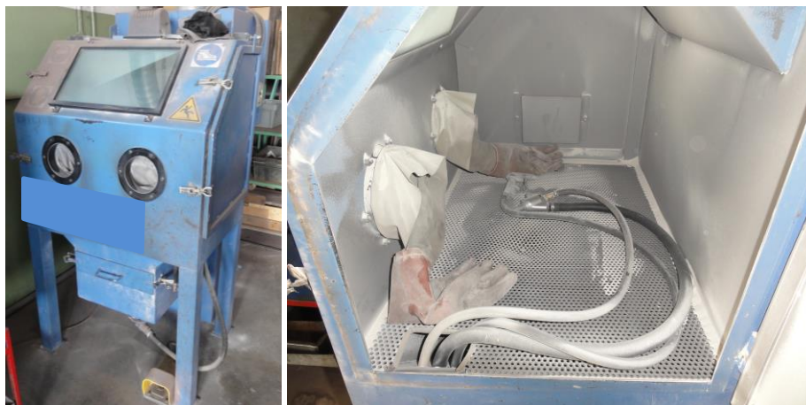
Figura 8.31 – Equipamento de jato de areia utilizado para remover a película de betume que envolve os agregados na superfície das lajetas
