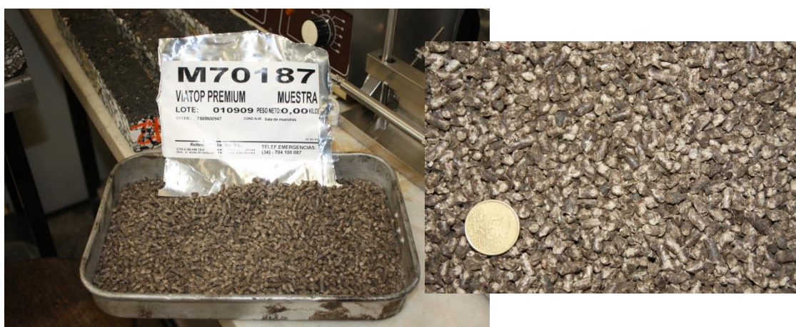
Figura 6.1 – Pormenor dos aglomerados de fibras celulósicas com adição de betume (Viatop® Premium) utilizadas no fabrico das SMA
