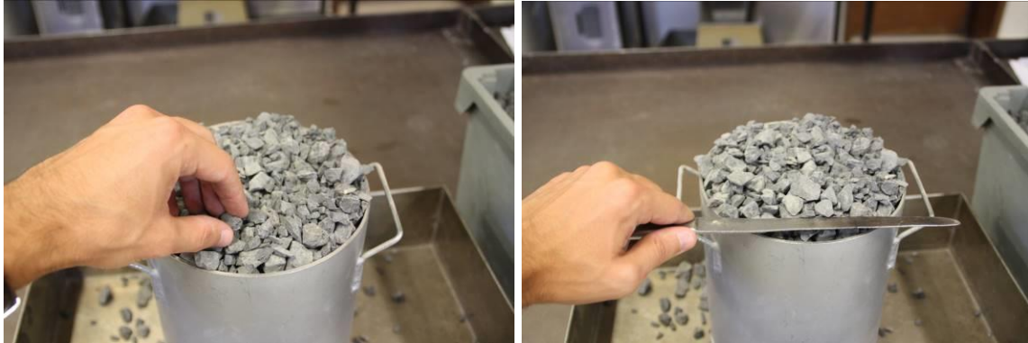
Figura 7.1 – Nivelamento dos agregados no recipiente
