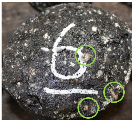
Figura 5.6 – Provette com aglomerados de fibras não dispersos na mistura SMA
