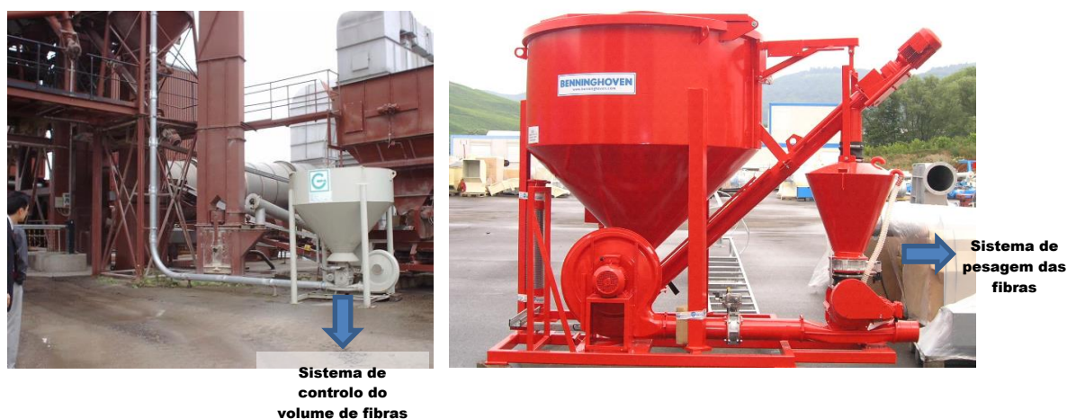
Figura 2.6 – Alimentador automático volumétrico (à esquerda, JRS, Rettenmaier, 2009) ou gravimétrico (à direita, Benninghoven, 2014b)
