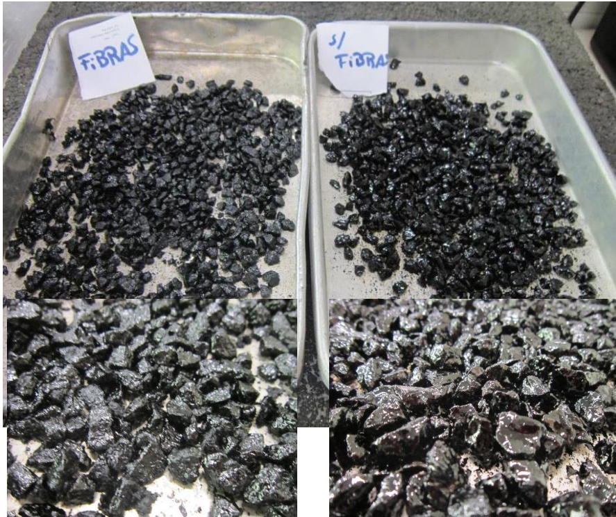
Figura 5.17 – Aspeto dos agregados revestidos com betume com e sem fibras celulósicas (0% e 1% de fibras celulósicas)
