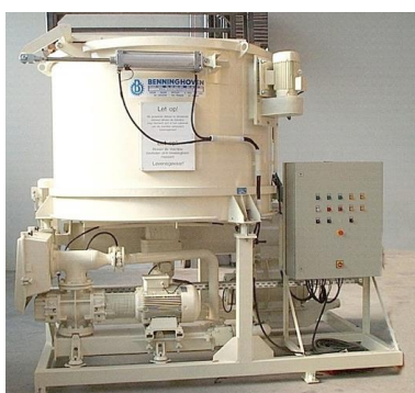
Figura 2.8 – Alimentador automático para adição de fibras celulósicas individuais (Benninghoven, 2014c)
