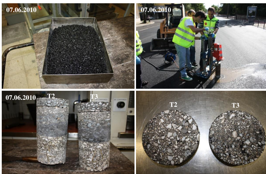
Figura 6.12 – Amostras de mistura SMA 12 com fibras celulósicas recolhidas na Avenida do Brasil
