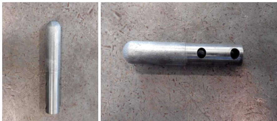
Figura 7.5 – Aspeto do pilão desenvolvido e fabricado para simular o varão utilizado no método de compactação com varão
