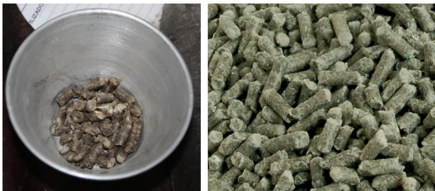
Figura 3.23 – Aspeto de fibras celulósicas aglomeradas com adição de betume e/ou de aditivos
