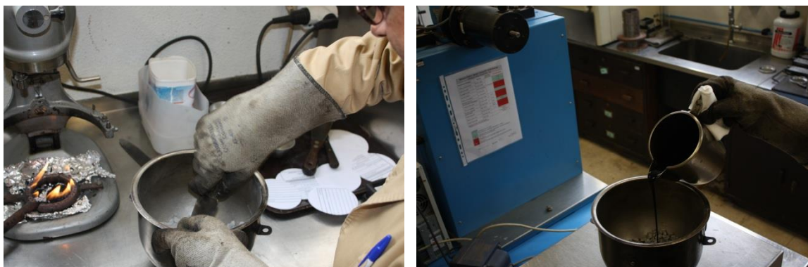
Figura 5.4 – Mistura do conjunto aquecido de agregados/filer e fibras no recipiente da misturadora (à esquerda) e adição de betume (à direita)
