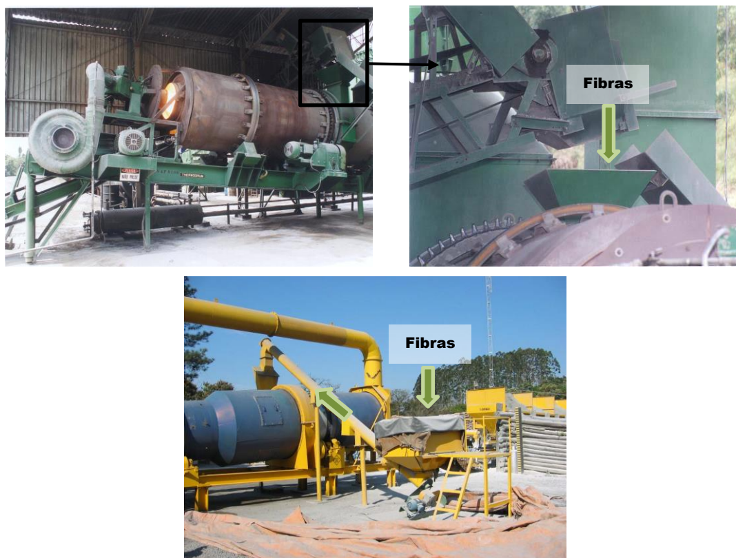
Figura 2.11 – Esquema de alimentação de fibras com alimentador automático na entrada para adição de mistura betuminosa reciclada (adaptado de JRS, Rettenmaier, 2005)
