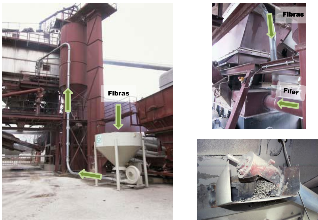
Figura 2.7 – Esquema de alimentação de fibras com alimentador automático (adaptado de JRS, Rettenmaier, 2009)
