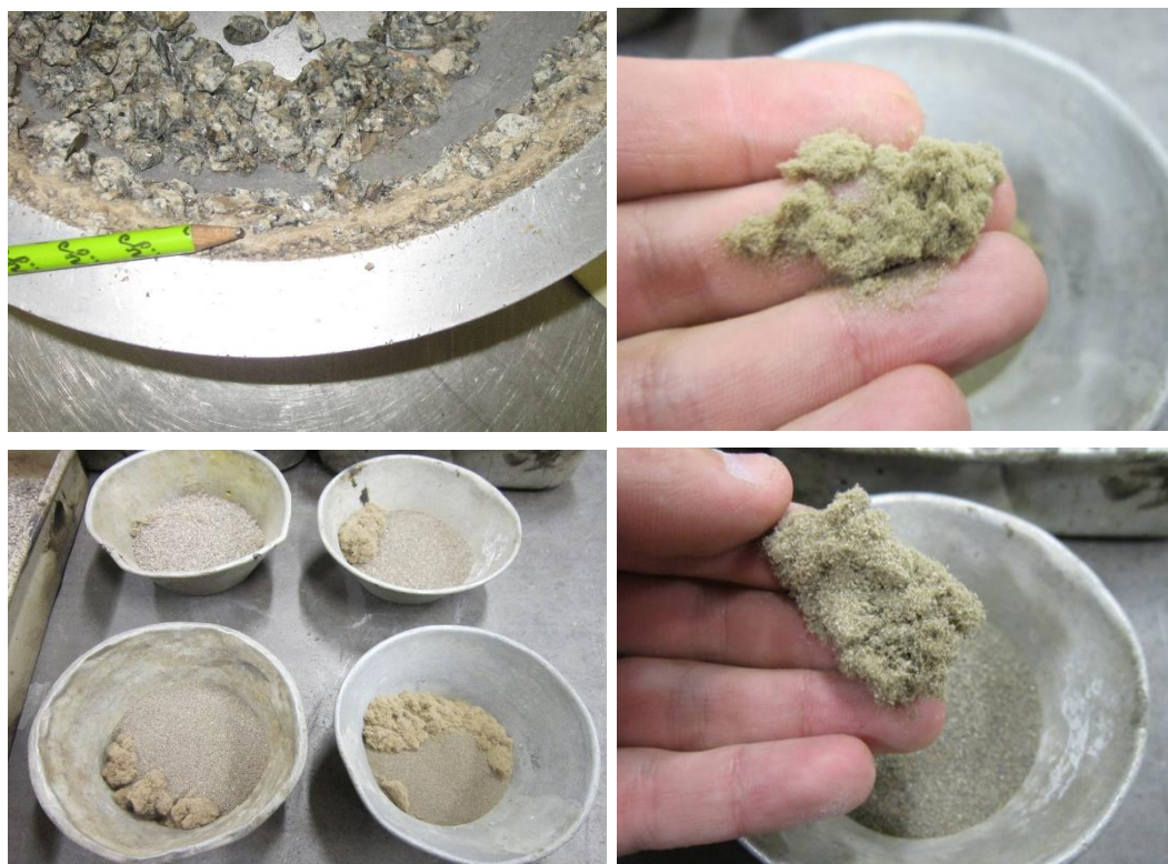
Figura 5.14 – Exemplos do aspeto das fibras celulósicas após extração do betume por centrifugação
