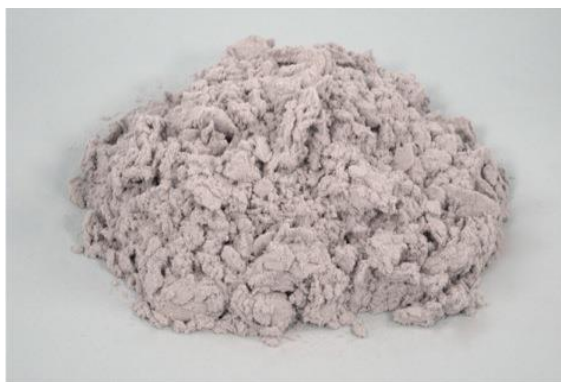
Figura 3.21 – Aspeto das fibras celulósicas individuais (Fiberand, 2014)
