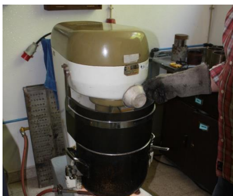
Figura 5.5 – Adição das fibras à temperatura ambiente à mistura betuminosa após “amassadura” durante um minuto
