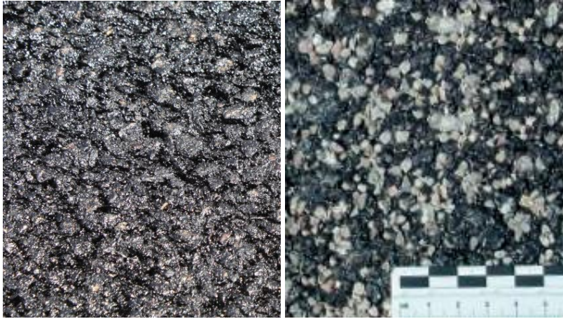
Figura 3.17 – Aspeto antes (à esquerda) e após espalhamento de agregados de pequena dimensão (à direita, Drueschner, 2006)
