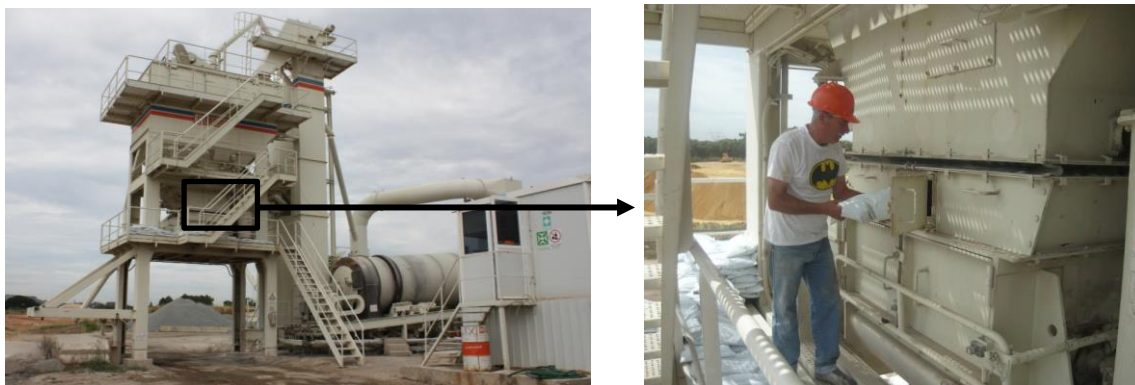
Figura 2.5 – Operador a introduzir um saco termo fundível de fibras celulósicas diretamente no misturador
