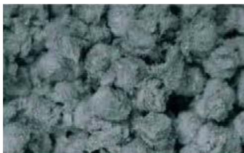
Figura 3.22 – Aspeto das fibras celulósicas aglomeradas sem adição de aglutinantes (Racanel & Burlacu, 2013)
