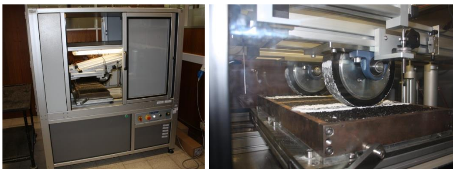
Figura 6.2 – Equipamento de ensaio de simulação para avaliação da deformação permanente e aspeto das lajetas durante o ensaio
