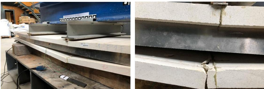
Figura 5-45 - Modo de rotura relativo ao ensaio à flexão do painel 1.
