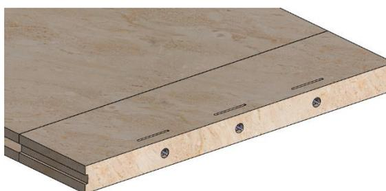
Figura 2-21 - Ancoragem passiva.
