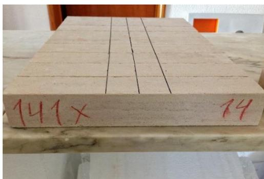
Figura 4-13 - Provetes de pedra "Branco Real": dimensões 300 mm x 50 mm x 50 mm.
