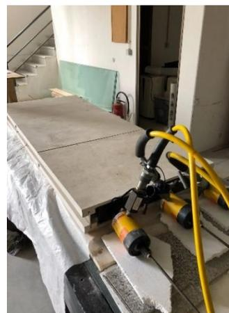
Figura 5-25 - Aplicação da carga de pré-esforço
