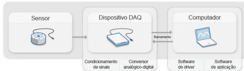
Figura 5-30 - Esquemática do sistema de aquisição de dados (Fonte: *National Instruments*).
