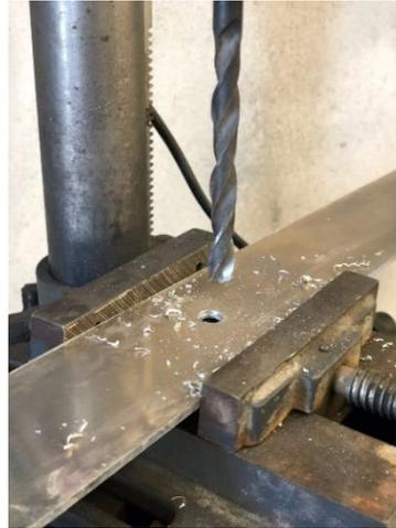
Figura 5-13 – Realização da furação na guia metálica.
