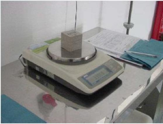
Figura 4-11 - Pesagem do provete.
