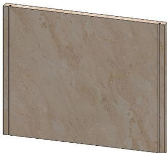
Figura 5-2 - Placa interior com rasgos nos bordos laterais.
