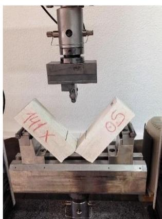
Figura 4-15 - Rotura de um provete durante o ensaio.
