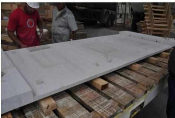
Figura 2-16 - Mesa de trabalho para a montagem dos painéis (Fonte: retirado de [14]).
