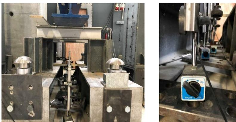
Figura 5-38 - Transdutores de deslocamento.
