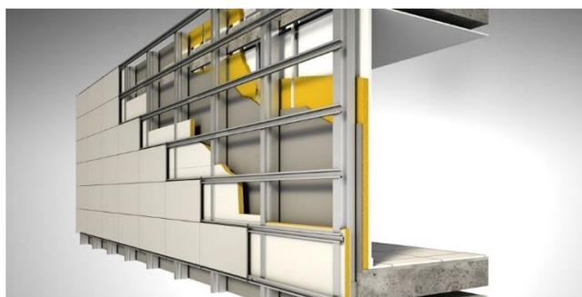
Figura 3-5 - Representação do sistema de fachada ventilada (Fonte: *Repinor – Serviços de Reabilitação*).
