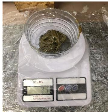
Figura 5-14 – Pesagem da mistura epóxi bi-componente.
