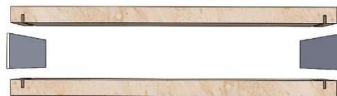
Figura 5-3 - Inclusão de guias metálicas para criação da caixa-de-ar.
