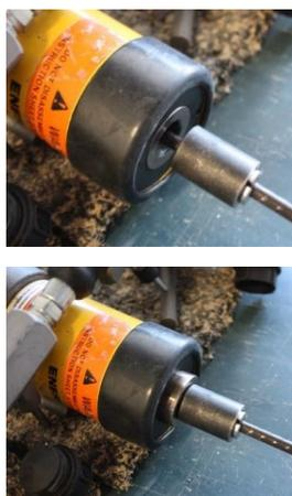
Figura 5-23 - Expansão dos cilindros hidráulicos
