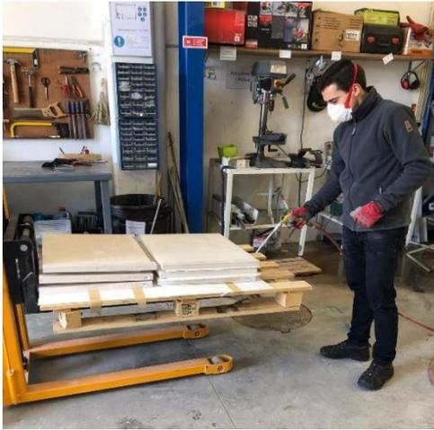
Figura 5-12 - Limpeza das placas de pedra com recurso a pistola de ar comprimido.
