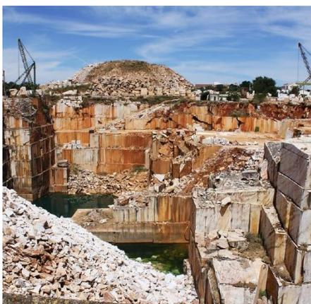
Figura 4-7 - Deposição de resíduos em áreas contíguas às frentes de exploração.
