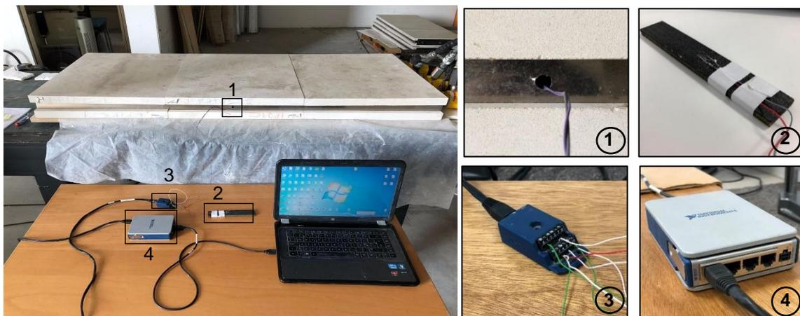
Figura 5-31 - Sistema de aquisição de dados: 1 – *sg* colocado no interior do painel; 2 – *sg* de compensação; 3 – bloco de terminais; 4 – dispositivo DAQ.
