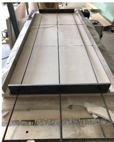
Figura 5-18 - Introdução das chapas de ancoragem e dos varões
