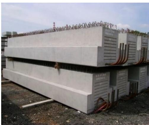
Figura 2-1 - Prefabricação pesada
