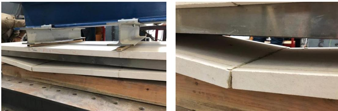
Figura 5-49 - Modo de rotura relativo ao ensaio à flexão do painel 2.
