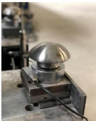
Figura 5-36 – Apoio com célula de carga
