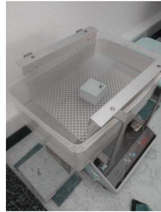
Figura 4-12 - Pesagem imersa do provete.
