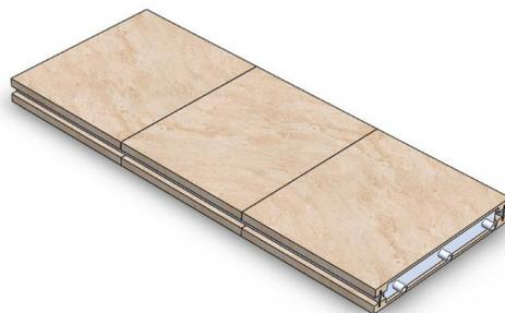
Figura 6-2 - Modelo geométrico utilizado na simulação numérica (dimensões do painel: 1500 x 600 x 120 [mm])
