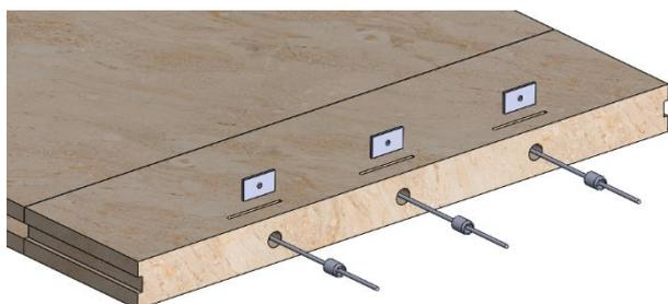
Figura 2-20 – Introdução das chapas de ancoragem e do sistema *cunha+barrilete*.
