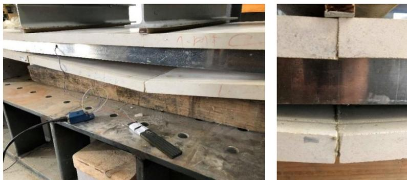
Figura 5-53 - Modo de rotura relativo ao ensaio à flexão do painel 3.
