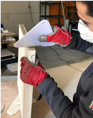
Figura 5-16 - Aplicação e espalhamento da resina.
