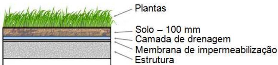
Figura 4.6 - Corte esquemático da cobertura verde; adaptado de (Auckland, 1998).
