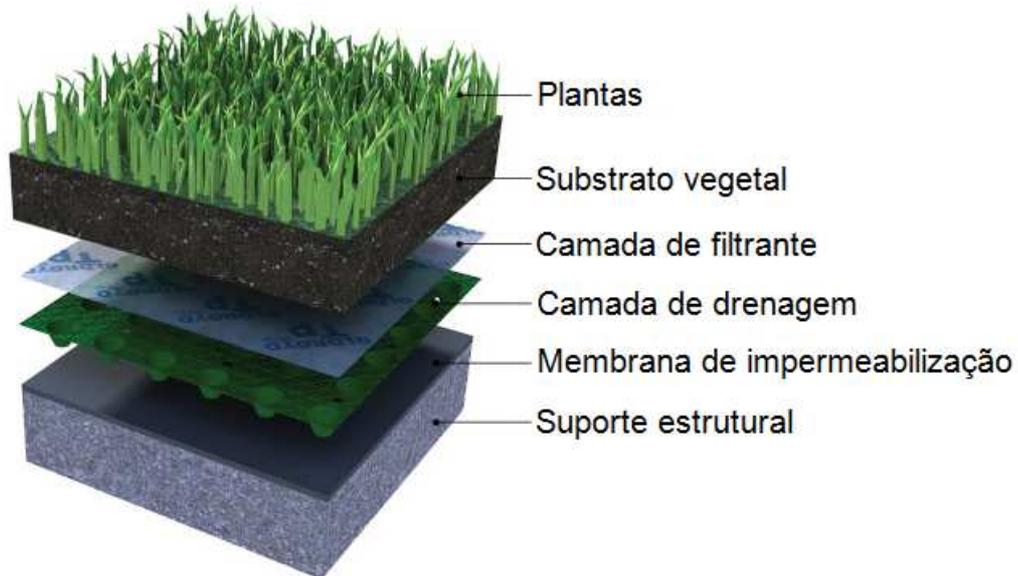
Figura 3.20 - Sistema sem isolamento térmico; adaptado de (Safeguardeurope).
