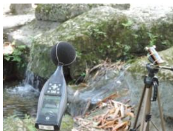
Fig. VI.79 Som de queda de água medido e gravado.
