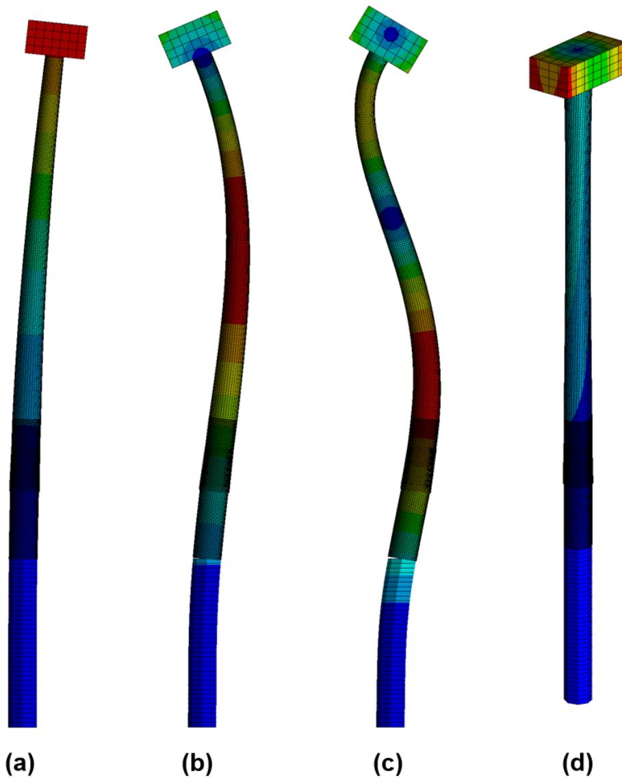
Figura 60 – (a) Primeiro modo de flexão (*side-side*); (b) Segundo modo de flexão (*side-side*); (c) Terceiro modo de flexão (*side-side*); (d) Primeiro modo de torção.
