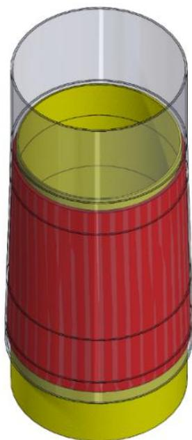
Figura 44 – Submodelo da ligação *grout*.
