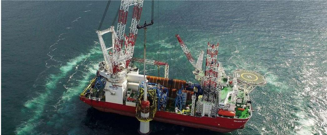
Figura 18 – Instalação da mono-estaca no mar [38].
