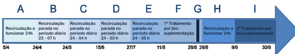
**Figura 17-** Diagrama temporal das medidas tomadas como combate à espécie filamentosa *Nocardia spp.* (Abril a Setembro de 2010)
