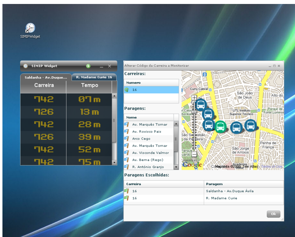
Figura 5.5: Aspecto funcional do protótipo concebido para renderizar localizações e horários em tempo real obtidos a partir da solução de integração do consórcio de operadores.
