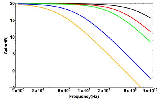
LNA\_B Gain (varying  $C_L$ )
