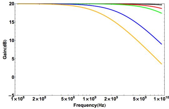
LNA\_A Gain (varying  $C_L$ )
