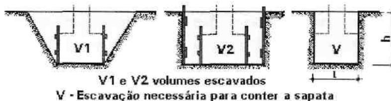
Figura 4: Diferentes modos de execução da escavação para implantação de uma sapata.
