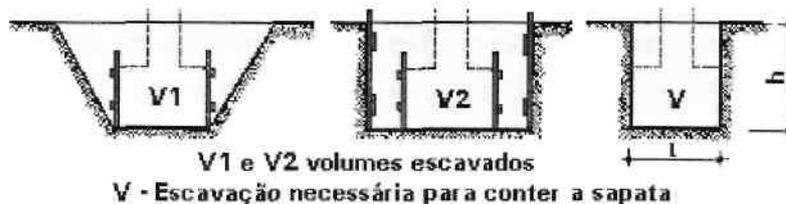
A largura e a altura a determinar para o cálculo do volume V, a considerar na medição, é o exclusivamente necessário para conter o volume da sapata.
