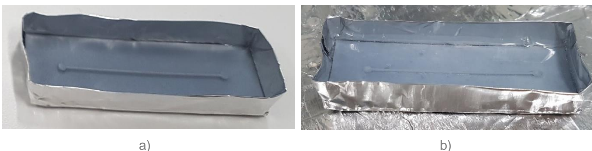
Figura 3.8: Molde envolto em fita de alumínio antes (a)) e depois (b)) de conter a mistura de PDMS.
