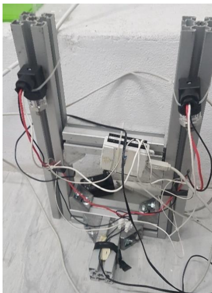
Figura 3.14: Sensores de pressão com o DAQ NI USB-6008 , fixos numa estrutura de perfis de alumínio.
