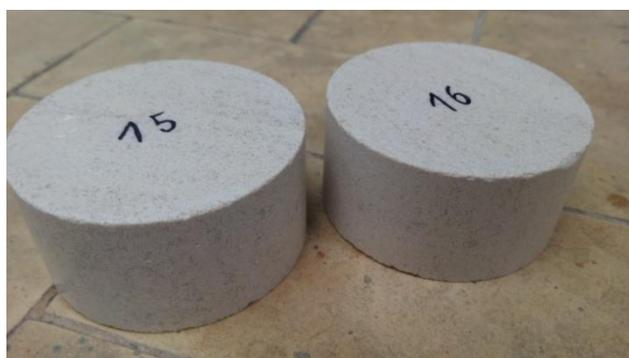
Figura 4.1 Provetes de rocha utilizados no ensaio edométrico.
