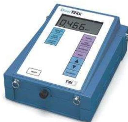
Figura 3.4 - Equipamento de medição de concentrações de partículas Dust track 8520 (TSI, 2006)
