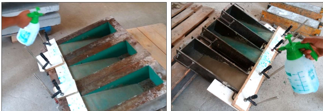
Figura 5.11 – Montagem dos perfis com superfície rugosa com retardador de presa (SRP) para os ensaios de corte inclinado com variação de ângulo.
