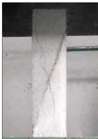
Figura 7.1 – Exemplo de formação simultânea de rotura pela interface e de rotura por fendilhação de um provete em ensaio de corte inclinado.
