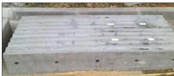
Figura 6.32 – Aspeto da superfície do tipo SO (ondulada) dos ensaios de corte longitudinal da série HICM.
