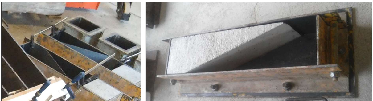
Figura 5.8 – Montagem dos perfis com superfície lisa (SL) para os ensaios de corte inclinado com variação de ângulo.
