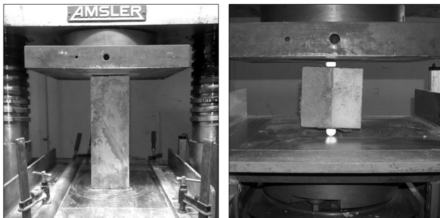
Figura 2.55 – Configuração dos ensaios de corte inclinado e dos ensaios splitting realizados por Santos (2009).
