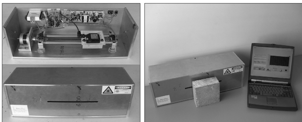
Figura 3.10 – 2D laser roughness analyzer desenvolvido por Santos & Júlio (2008).
