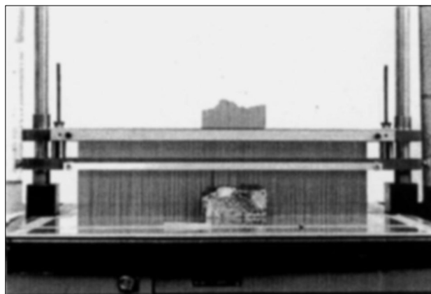
Figura 3.4 – Equipamento para leitura de rugosidades através de cortina de agulhas. (imagem retirada de [Abu-Tair et al. (2000)])
