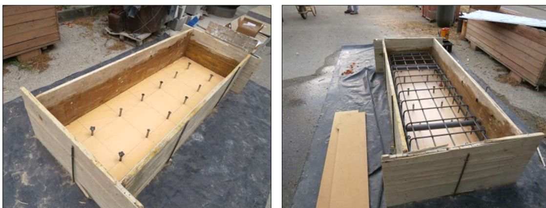
Figura 6.23 – Preparação da laje utilizada nos ensaios da série ACC (arrancamento de conetores do lado da cabeça).
