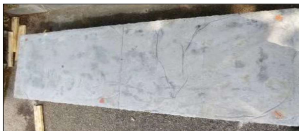
Figura 6.29 – Aspecto da superfície tipo SL (superfície lisa) dos ensaios de corte longitudinal da série HICM.
