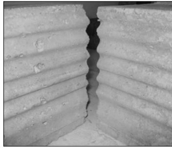
Figura 4.15 – Exemplo de interface ondulada para ensaios de corte direto.
