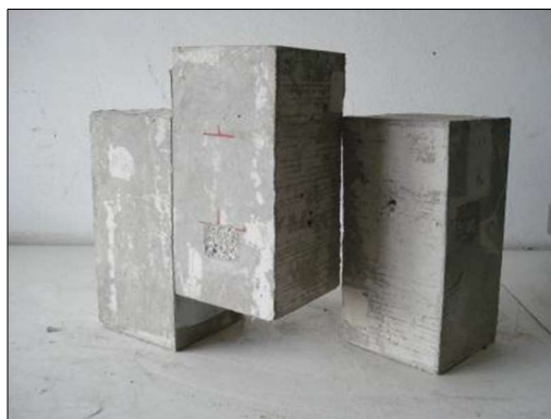
(i) Rotura pelo aço
