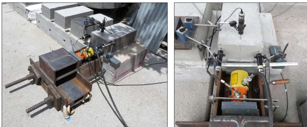
Figura 6.40 – Configuração dos ensaios de corte longitudinal da série HICM.
