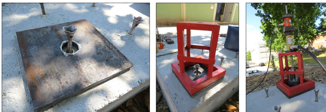
Figura 6.27 – Montagem dos ensaios da série HAB (avaliação do conetor ao arrancamento no betão).
