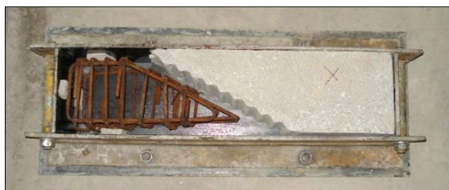
Figura 4.2 – Cofragem para execução dos provetes para ensaios de corte inclinado.
