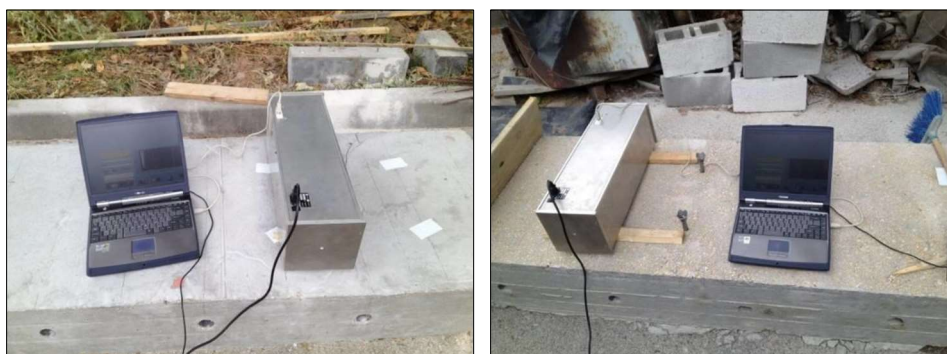
Figura 6.33 – Medição de perfis de rugosidades com rugosímetro laser 2D sobre as superfícies adotadas nos ensaios de corte longitudinal da série HICM.
