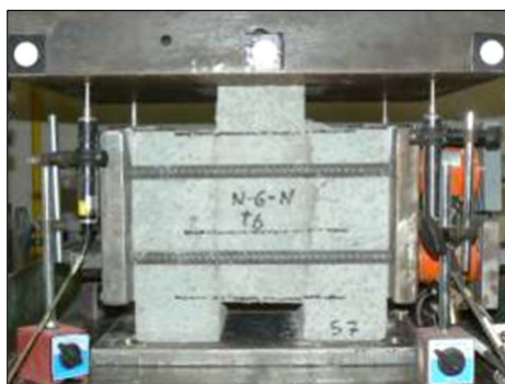
Figura 7.8 – Esquema de ensaio e geometria e dimensões dos provetes adotados nos ensaios de duplo corte direto, de Costa (2012).
