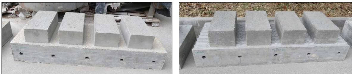
Figura 6.37 – Provetes para execução dos ensaios de corte longitudinal da série HICM.
