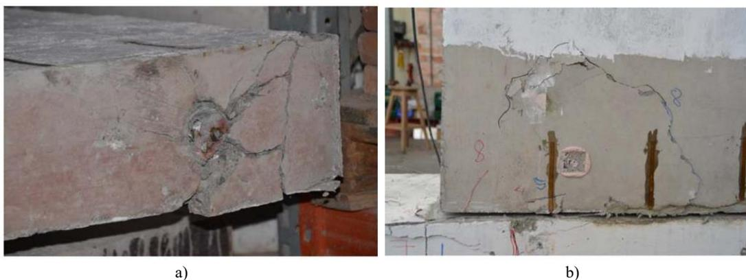
Figura 38 - Danos observados: a) modelo A1D25M-G [10]; b) modelo A1D25C-G [10].
