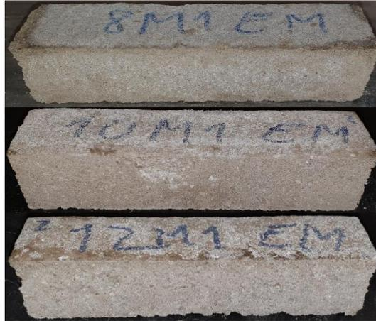
Figura 4.30: Variação da eflorescência das famílias com sílica aos 7 dias de idade nas famílias 8M1, 10M1 e 12M1.
