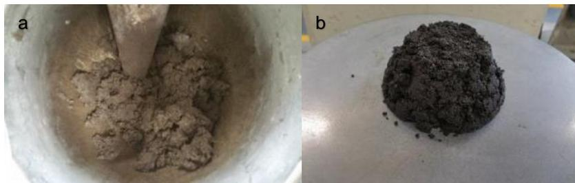
Figura 4.4: Argamassa seca com aglomeração do material (a) e ensaio do espalhamento (b) da AE1.
