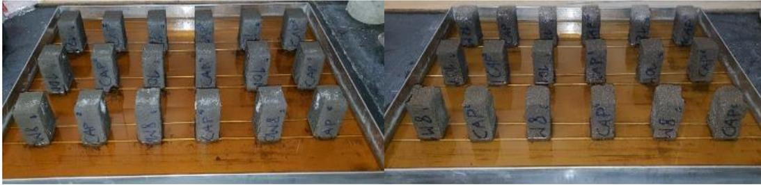
Figura 4.38: Lixiviação e degradação dos provetes no fim do ensaio; Esquerda: 8M0, 10M0 e 12M0; Direita: 8M1, 10M1 e 12M1.
