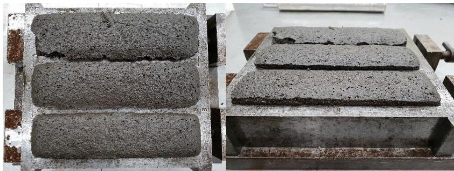
Figura 4.21: Expansão após a colocação da argamassa com sílica no molde.
