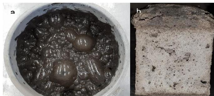
Figura 4.41: Produção de gás durante a amassadura (a) e aumento de volume do provete (b).
