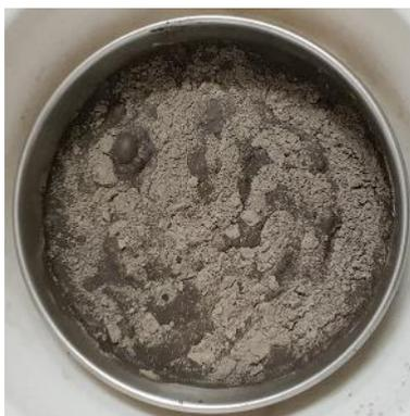
Figura 4.1: Comportamento hidrofóbico das CFRSU no início da análise granulométrica.
