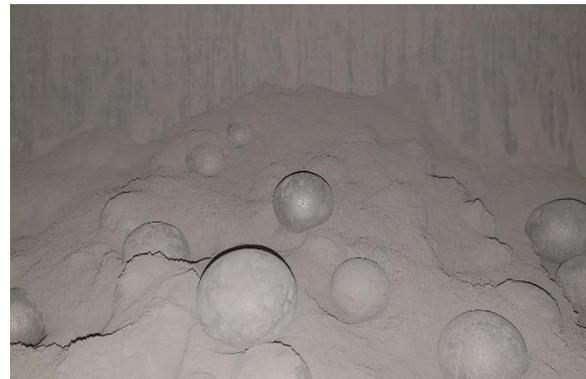
Figura B: Moinho grande e o seu interior com a CFRSU.
