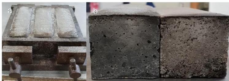
Figura 4.7: a) Molde com argamassa da AE9; b) provete da AE9 à esquerda e da AE8 à direita.
