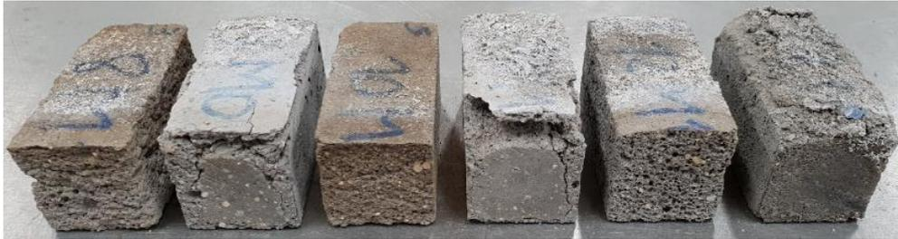
Figura 4.35: Degradação dos provetes no ensaio de absorção capilar: 8M1, 8M0, 10M1, 10M0, 12M1 e 12M0.
