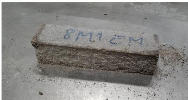
Figura 4.29: Desintegração do provete da família 8M1 devido às eflorescências aos 7 dias de idade.
