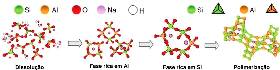
Figura 2.5: Modelo da formação do gel N-A-S-H. Adaptado de Krivenko (2017).
