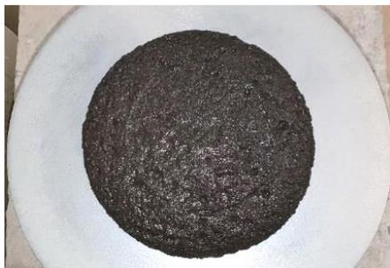
Figura 4.18: Ensaio da consistência por espalhamento aos 15 minutos de 8M0.
