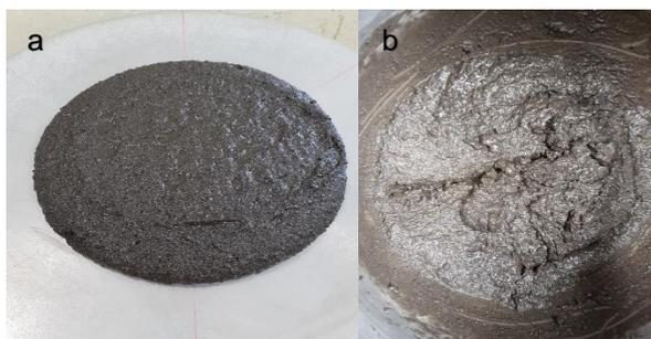
Figura 4.8: Ensaio do espalhamento da AE10 (a) e mistura da AE11 (b).
