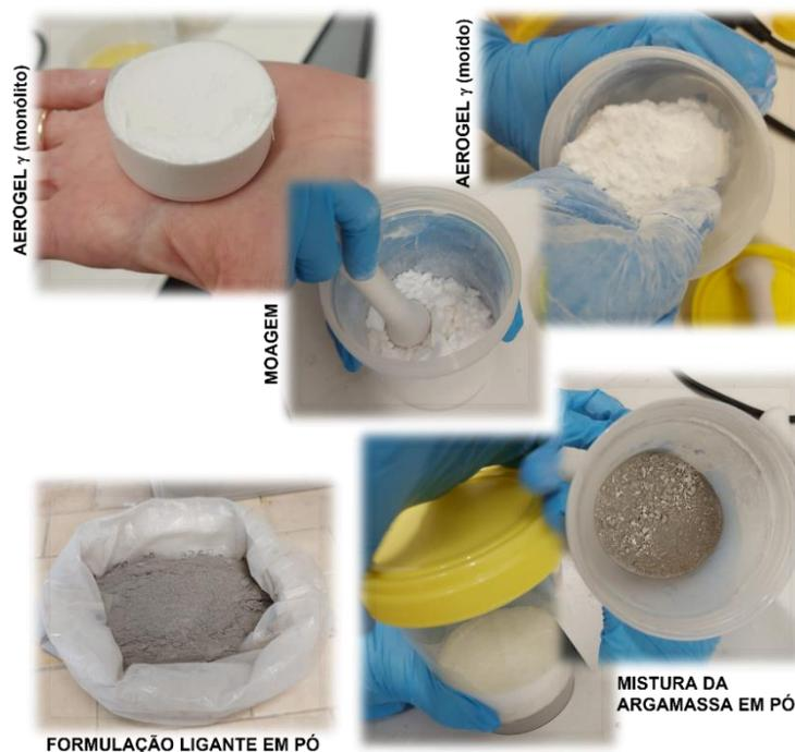
**Figura 46.** Moagem do aerogel  $\gamma$  e mistura do aerogel com a formulação em pó.
