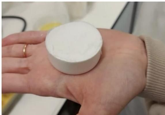
Figura 36. Amostra de aerogel híbrido  $S_5$  com 4,5 cm de diâmetro e 2 cm de espessura.
