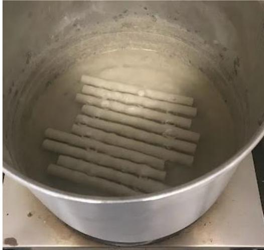
Figura 5 Provetes durante fervura
