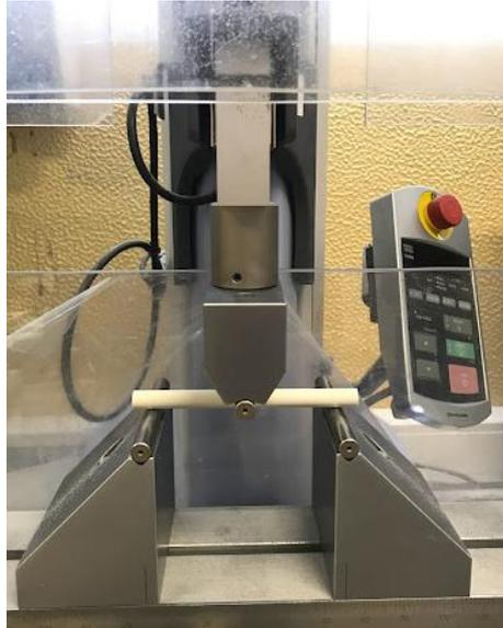
Figura 6 Método de flexão em 3 pontos
