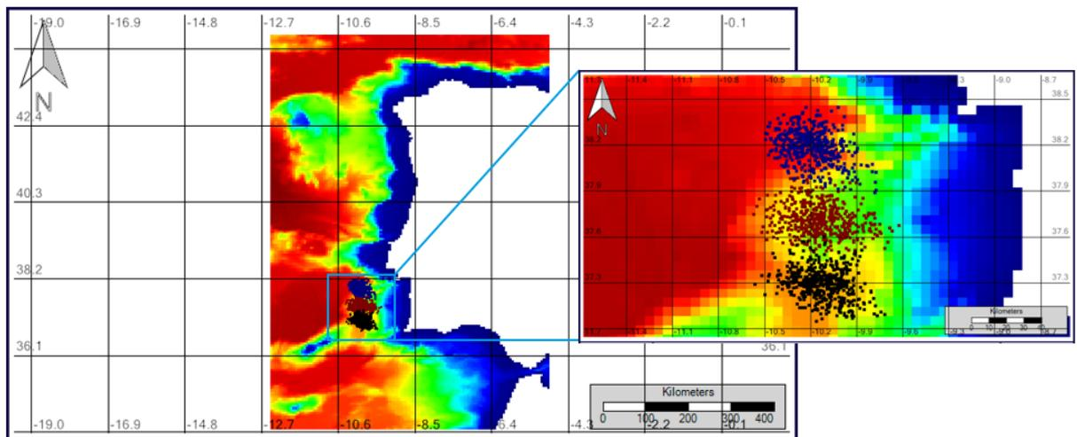
FIGURE 58 – OIL SLICK LOCATION FOR WIND COEFFICIENT ON THE 18<sup>TH</sup> JULY (BROWN – REFERENCE RUN; DARK BLUE – WIND COEFFICIENT 0.02; BLACK – WIND COEFFICIENT 0.04)
