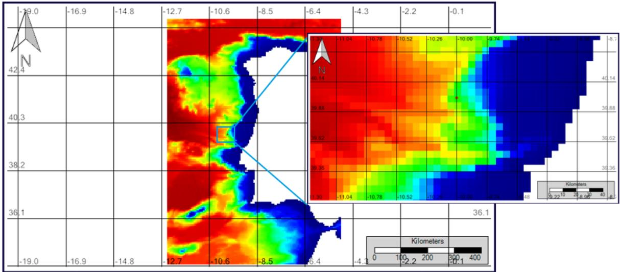
FIGURE 69 – OIL SLICK LOCATION FOR THE WAVE FORCING ANALYSIS ON THE 11<sup>TH</sup> JULY (BROWN – REFERENCE RUN; DARK BLUE – WAVE HEIGHT +20; BLACK – WAVE HEIGHT -20; WHITE – WAVE PERIOD +20; RED – WAVE PERIOD -20)
