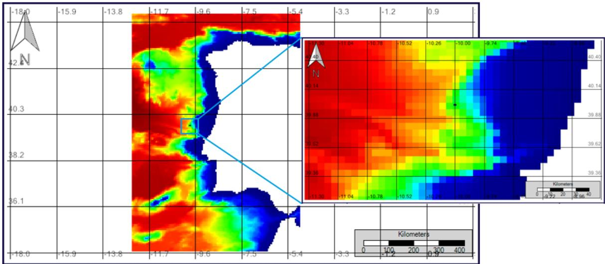
FIGURE 56 – OIL SLICK LOCATION FOR WIND COEFFICIENT ON THE 11<sup>TH</sup> JULY (BROWN – REFERENCE RUN; DARK BLUE – WIND COEFFICIENT 0.02; BLACK – WIND COEFFICIENT 0.04)
