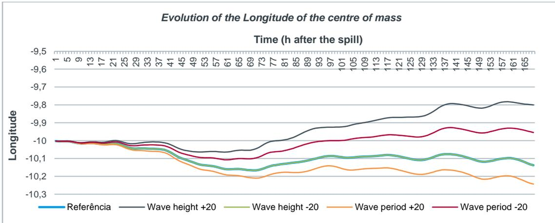
FIGURE 63 - EVOLUTION OF THE CENTRE OF MASS LONGITUDE IN THE WAVE FORCING ANALYSIS.
