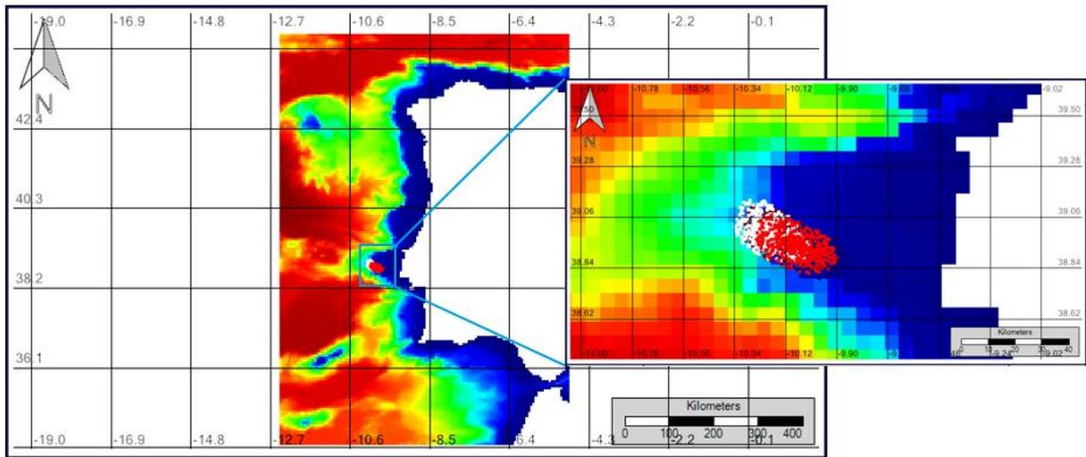
FIGURE 70 - OIL SLICK LOCATION FOR THE WAVE FORCING ANALYSIS ON THE 14<sup>TH</sup> JULY (BROWN – REFERENCE RUN; DARK BLUE – WAVE HEIGHT +20; BLACK – WAVE HEIGHT -20; WHITE – WAVE PERIOD +20; RED – WAVE PERIOD -20)
