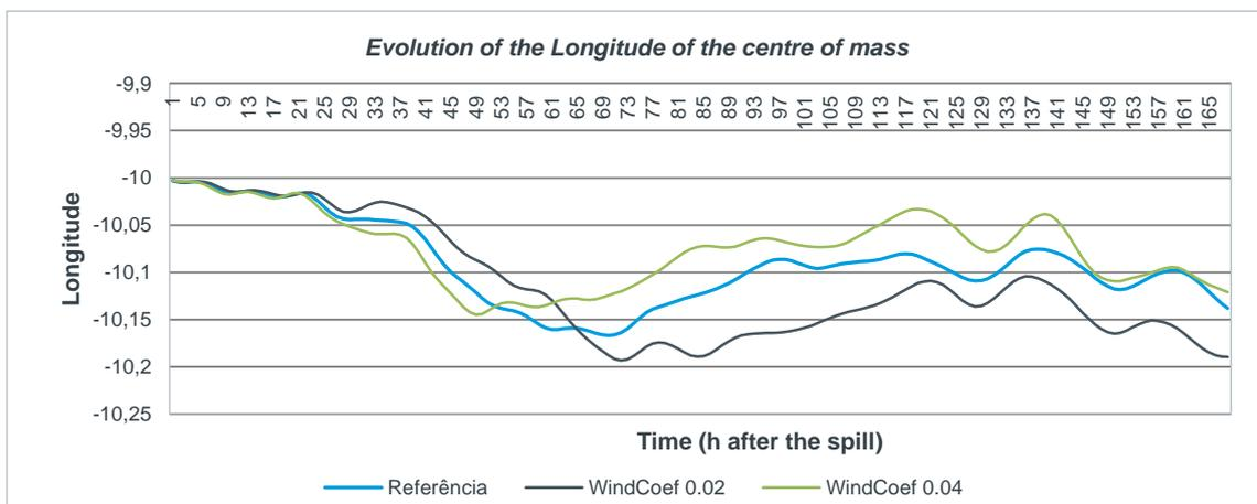
FIGURE 52- EVOLUTION OF THE CENTRE OF MASS LONGITUDE IN THE WIND COEFFICIENT ANALYSIS.
