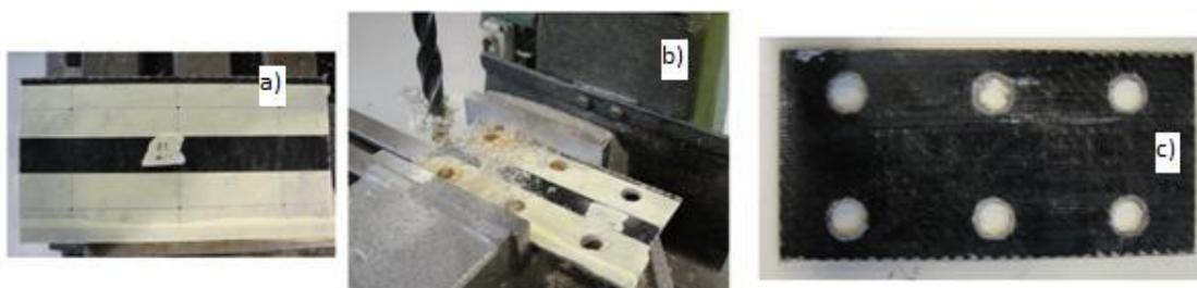
Figura 32 - Furação dos provetes: a) marcação de pontos b) furação c) provete final.
