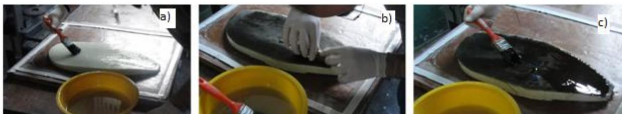
Figura 34 - a) Imagem da primeira aplicação de resina no molde, b) aplicação da primeira camada de fibra e passagem do rolete c) aplicação da resina para a segunda camada de fibras.
