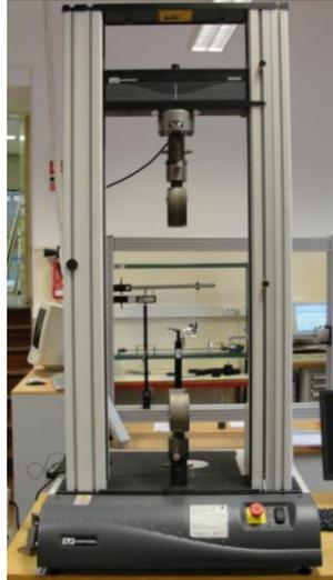
Figura 40 - Máquina de ensaios eletromecânica Instron 3369
