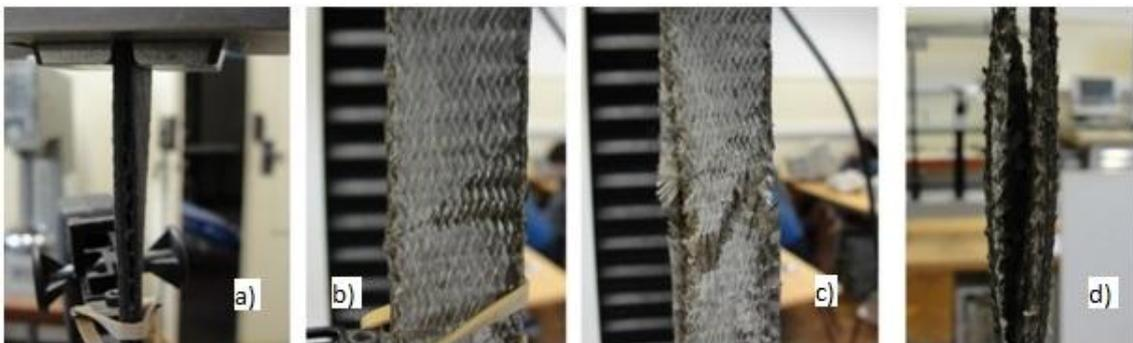
Figura 74 - Fases típicas de um ensaio de um provete da placa 1: a) - Fissuração ao meio ao longo do meio da espessura da placa, b) - Início da estricção ao longo de todo o provetes das fibras c) e d)- Expulsão da camada de resina do interior da placa até à cedência do provete.
