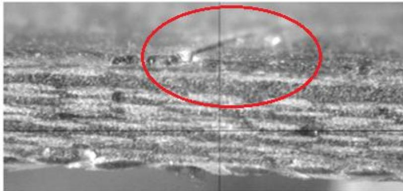
Figura 54 - Fissura decorrente do processo de cura, e que se inicia na superfície da placa e se propaga até à primeira camada de fibra
