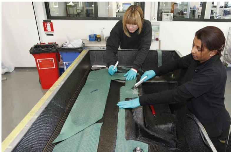
Figura 19 - Aplicação de fibras de carbono na construção do chassis do Lamborghini Aventador V12L [39]
