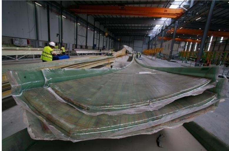
Figura 18 - Utilização de fibra de vidro nas pás de torres eólicas [37].
