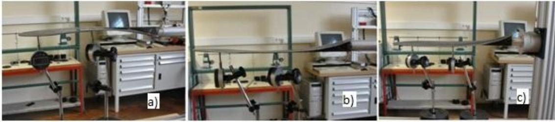
Figura 82 - Imagens das 3 montagens: a) - Pá 1 posição invertida, b) - Pá 1 posição normal, c) - Pá 2 posição normal
