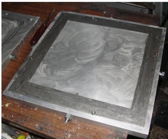
Figura 29 - Base do molde de alumínio com uma camada de cera desmoldante, com o aro de alumínio e os quatro pinos-guia
