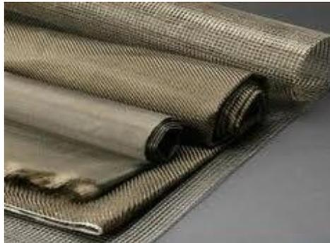
Figura 14 - Vários tipos de entrelaçados de fibras de basalto [33].
