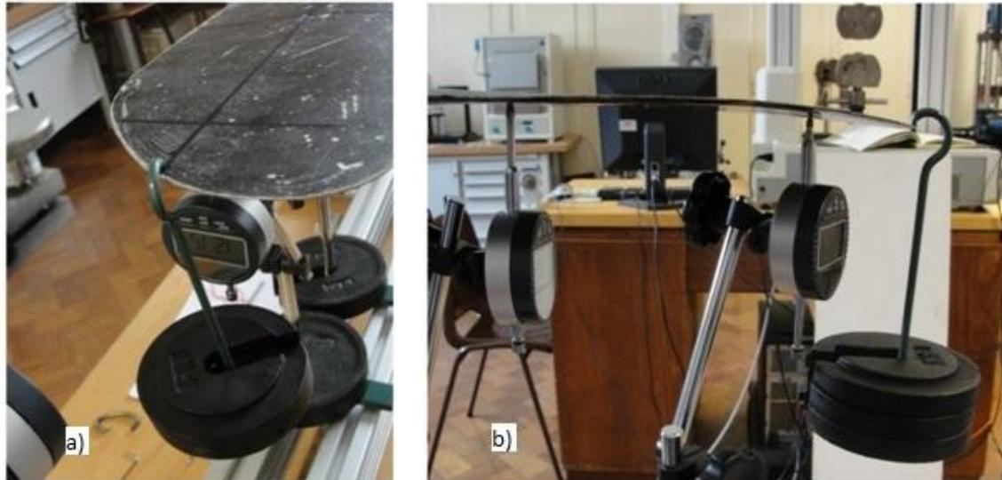
Figura 83 - Duas imagens que mostram a pá do remo sob carregamento: a) - Imagem onde é possível ver os pontos de referência utilizados, b) - Deslocamento provocado pelo carregamento
