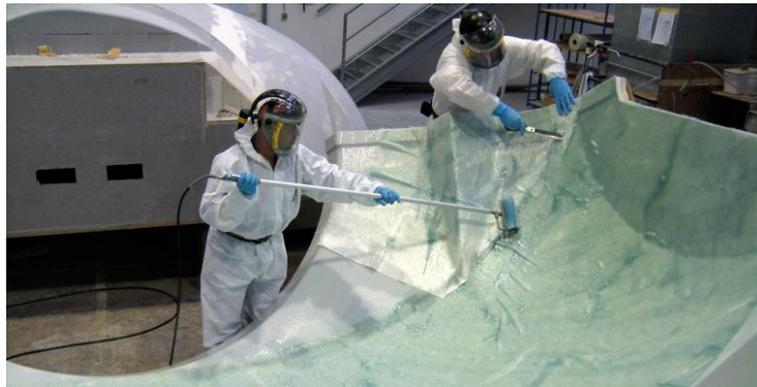
Figura 10 - Aplicação do processo HLU num molde de grandes dimensões [25]
