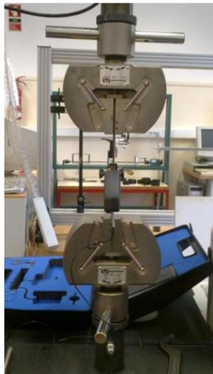
Figura 41 - Ensaio de tração
