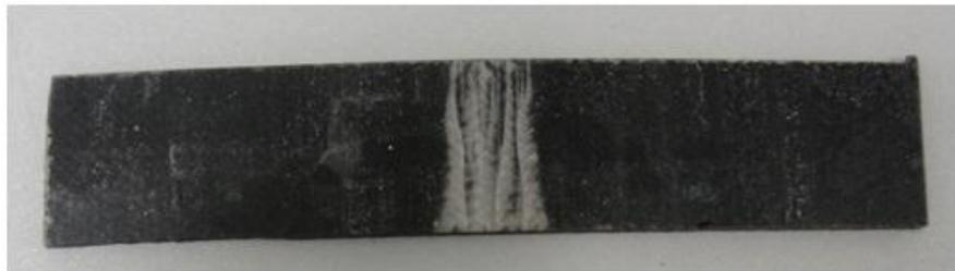
Figura 70 - Imagem do único provete com alinhamento  $\pm 45^\circ$  que fraturou
