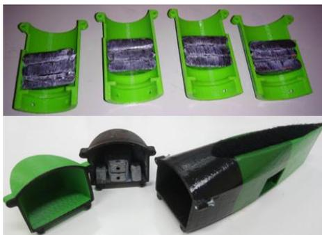
(a) Aplicação de lastros de chumbo nas carengens frontais e na fuselagem.
