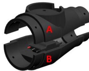
Figura 5.5: Modelo 3D da carenagem central para o modo VTOL (2).
