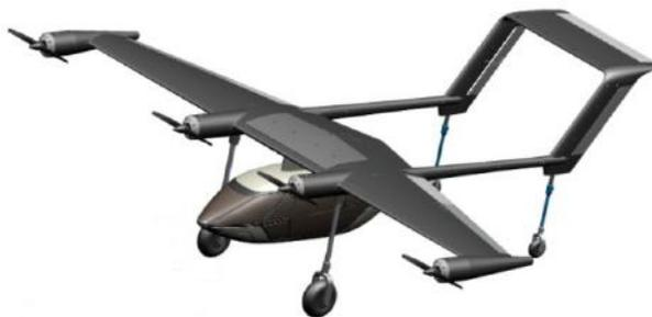
Figura 3.1: Modelo CAD da versão escalonada 1 por 10 da aeronave *Flexcraft* [46].
