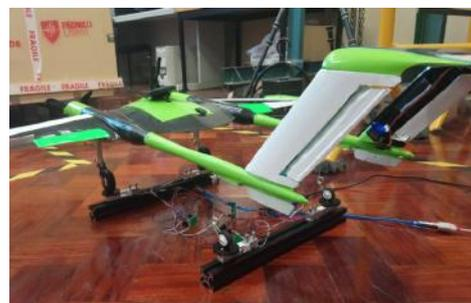
Figura 7.5: Esquema de medição do CG.
