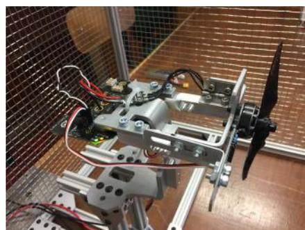
Figura 7.2: Aparelho de medição utilizado na análise dos motores elétricos.
