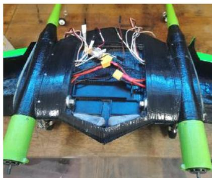
(b) *Canopy* central com a passagem de cablagem, suportes para os instrumentos, varões de aço e lastros de chumbo.
