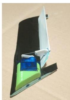
(c) Estabilizador vertical com o varão de carbono, vinil e suporte para o servo.
