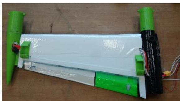
(d) Intradorsos da asa principal montada entre as carenagens lateral e central com cablagem.
