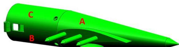
Figura 4.4: Modelo 3D da carenagem lateral (2).
