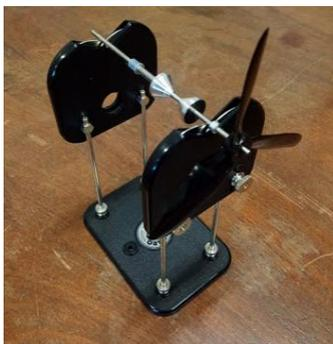
Figura 7.1: Método de balanceamento das hélices.
