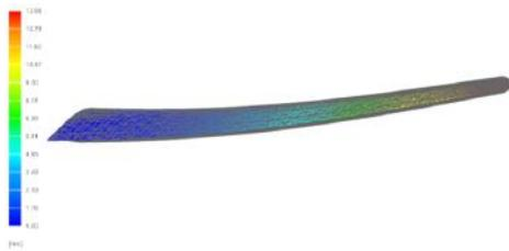
Figura 4.25: 1º modo de vibração para 28.6 Hz.
