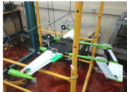
Figura 7.9: Esquema de medição dos momentos de inércia em torno de  $z$ .
