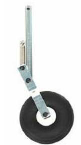
Figura 3.15: Trem de aterragem dianteiro utilizado [68].
