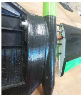
(c) Fixação do varão de aço na *canopy* central e encaixe da asa principal.
