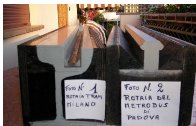
Figura 3.13 – Comparação entre um carril de um elétrico comum (esquerda) e de um Translohr (direita) (Pierre, 2010)
