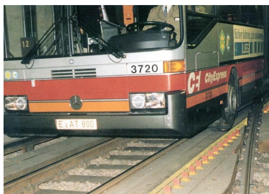
Figura 3.8 – SGMec a partilhar a via com um sistema ferroviário, em Essen (Smiler (c), S.d.)
