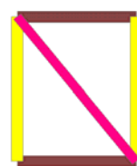
Fig. 28 - Esquema de um elemento diagonal de um frontal, entre travessas e prumos
