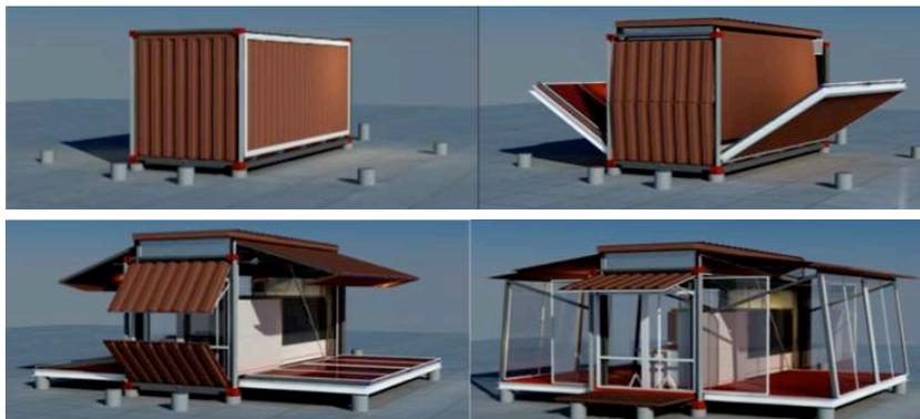
**Figura 1.21.** | Sequência de montagem de EBS block.
