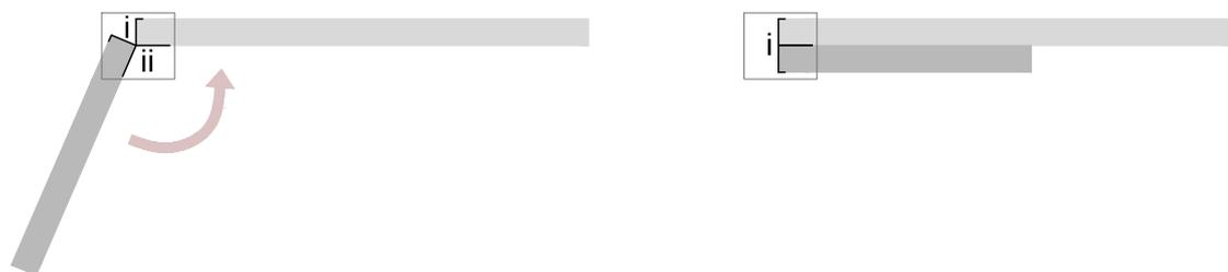
**Figura 4.34.** | Exemplo do tipo de rotação à qual duas placas devem estar sujeitas, sendo para isso necessário que as juntas contribuam para o movimento.
