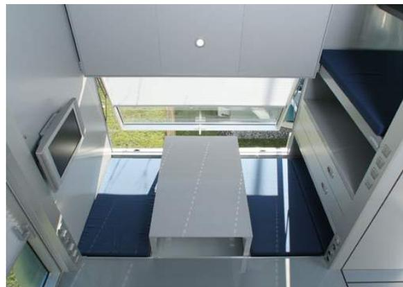
**Figura 1.12.** | Interior da Micro-Compact Home com pormenor da mesa de comer que se transforma em cama.
