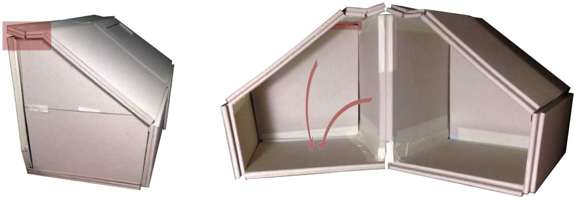
**Figura 4.40.** | A vermelho está especificado um dos cantos estruturalmente críticos; as setas indicam o movimento das placas a contrariar.
