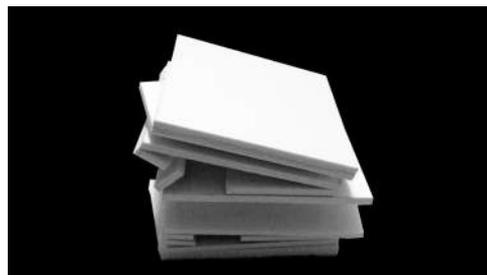
Definidas as dimensões e os métodos mecânicos de funcionamento da peça, foi efetuada uma maquete à escala 1:5 com espessuras de materiais e encaixes de placas definidos. Com este modelo plástico tridimensional foi possível perceber pontos estruturalmente críticos e quais os locais onde o travamento de placas deverá acontecer.
