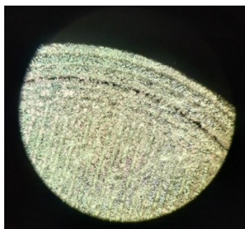
Figura 3.6: Delaminação identificada em alguns dos provetes cilíndricos com 6 camadas externas.
