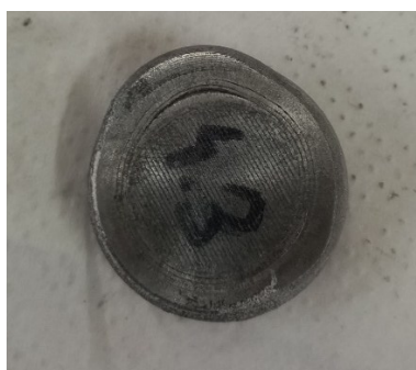
Figura 4.21: Provette cilíndrico com quatro camadas externas que, ao ensaiado à compressão, exibiu delaminação.
