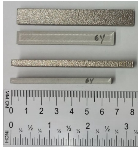
Figura 4.8: Distinção dimensional entre os provetes e flexão SLM e FFF (lapso na inclusão do fator de escala).
