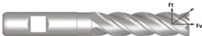
Figura 6: Forças na fresa [15]
