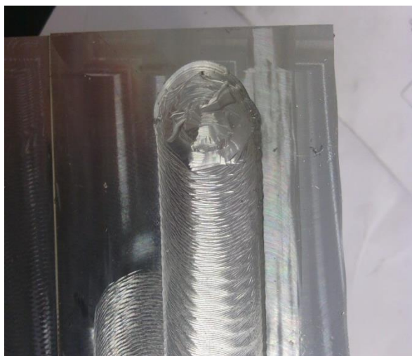
Figura 47: Sulco deixado aquando da fratura da ferramenta
