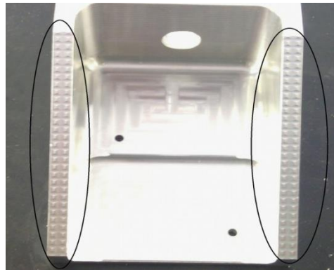
Figura 60: Marcas deixadas pela operação de acabamento nas paredes diagonais
