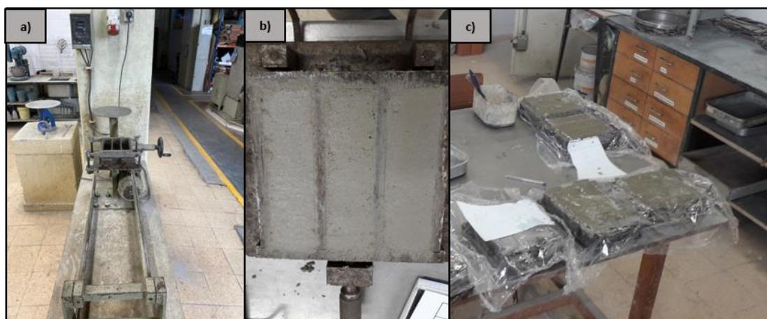
Figura 3.9 – a) Mesa de compactação; b) Molde preenchido com argamassa e rasado; c) Colocação de película plástica para evitar evaporação.
