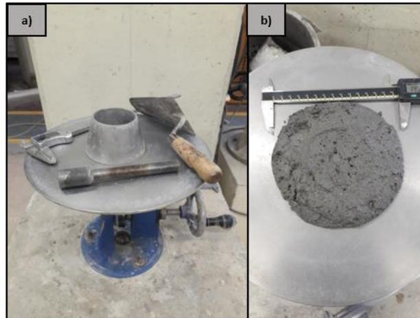
Figura 3.11 – a) Materiais utilizados no ensaio de espalhamento; b) Medição do diâmetro resultante do ensaio.
