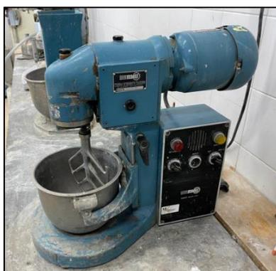
*Figura 3.7 – Misturadora utilizada na produção das argamassas.*
