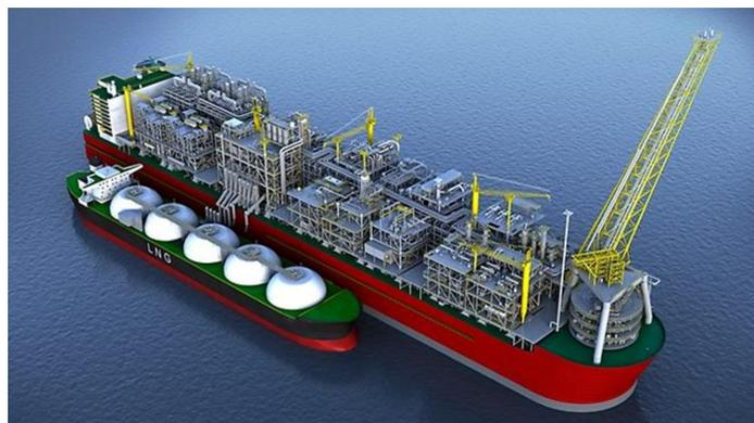
**Figura 14- Configuração STS (Side-to-Side) entre a FLNG do tipo 'turret' e o navio aliviador LNG (<http://www.nihonenergy.blogspot.com>)**
