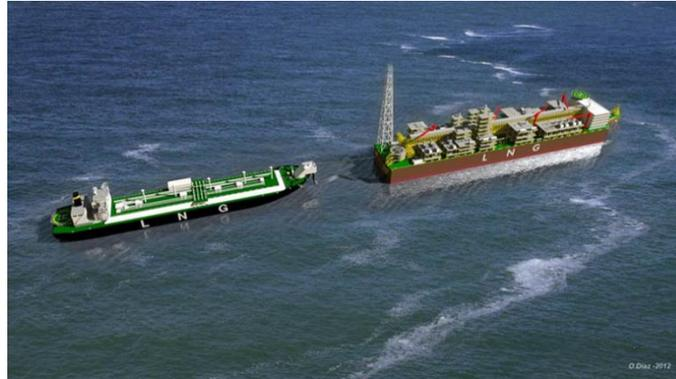
**Figura 15- Configuração 'tandem' entre a FLNG e o navio aliviador LNG (<http://www.saipem.com>)**
