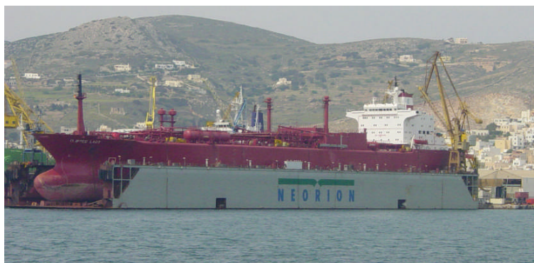
Figura 7 – Exemplo de uma doca flutuante
