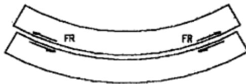
Figura 2.3 – Comportamento de duas vigas devido a uma carga vertical [2]
