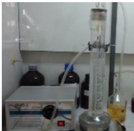
Figura 8.1 – Instalação laboratorial utilizada para aplicação da ozonização ao efluente SBR
