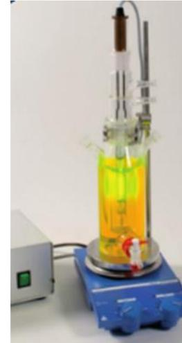
Figura 8.2 – Espectro de emissão da lâmpada de mercúrio de média pressão Heraeus Noblelight TQ 150 (à esquerda); Fotorreator com camisa interna de quartzo utilizado para os testes de irradiação UV aplicados ao efluente do SBR, com a lâmpada UV instalada (à direita).
