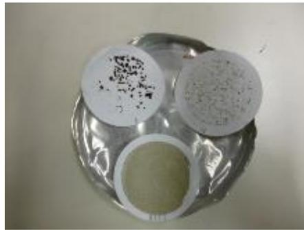
Figura 7.2 – Exemplo da determinação dos TSS de cada uma das frações das lamas granulares aeróbias (em cima à esquerda fração > 0,65 mm, em cima à direita fração entre os 0,65-0,25mm e em baixo fração <0,25 mm).
