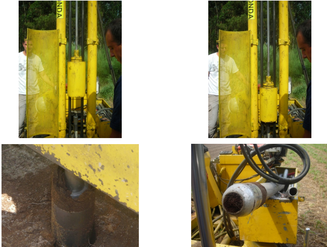
Figura 6.3- Recolha de amostras de sedimentos da zona não saturada com sondagens mecânicas com cravação dinâmica do amostrador. Este método assegura a recolha de amostras representativas do meio.
