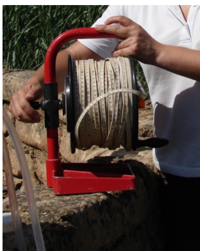
Figura 5.7- Medição da profundidade do nível de água e da captação.
