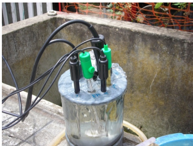
Figura 5.8- Monitorização dos parâmetros físico-químicos na célula de fluxo em ligação directa com a água bombeada da captação.
