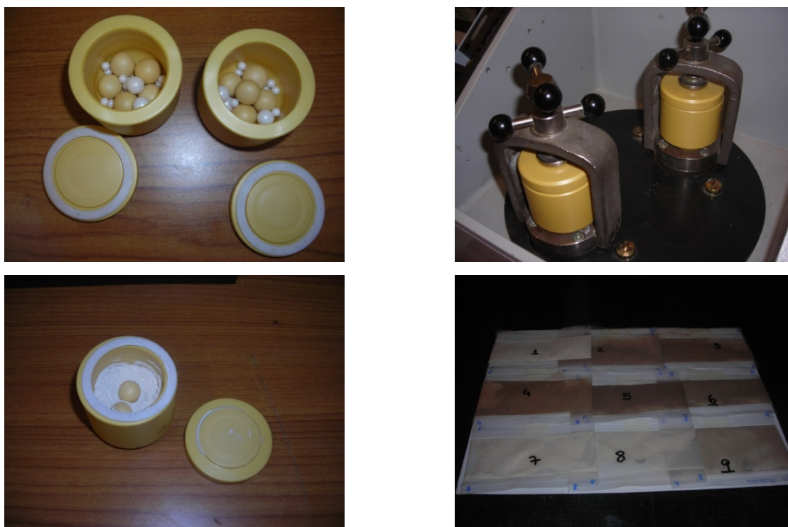
Figura 6.11- Em cima: moinhos de bolas de zircónio. Em baixo: amostra moída a < 80 mesh (à esquerda) e amostras embaladas para análise multi-elementar no Canadá (à direita).
