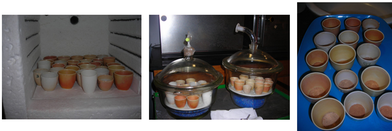
Figura 6.6- Vários aspectos da determinação do teor de matéria orgânica nos sedimentos. Da esquerda para a direita: cadinhos de porcelana na mufla; arrefecimento das amostras nos excicadores; aspecto das amostras após a eliminação da matéria orgânica.
