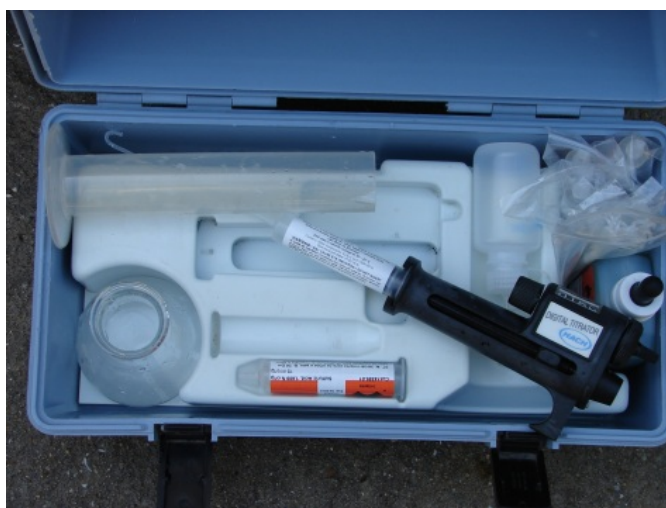
Figura 5.9- Determinação da alcalinidade por titulação colorimétrica das águas amostradas e kit HACH® utilizado nessas determinações.
