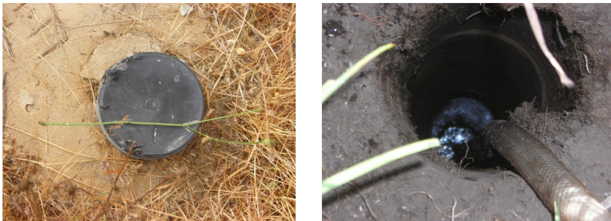
Figura 5.4- À esquerda, piezômetro 57 que capta o aquífero profundo com nível a 11 m de profundidade. À direita ponta filtrante que capta o aquífero superficial, sendo possível observar a pequena profundidade a que se encontra o nível de água nesta unidade aquífera.
