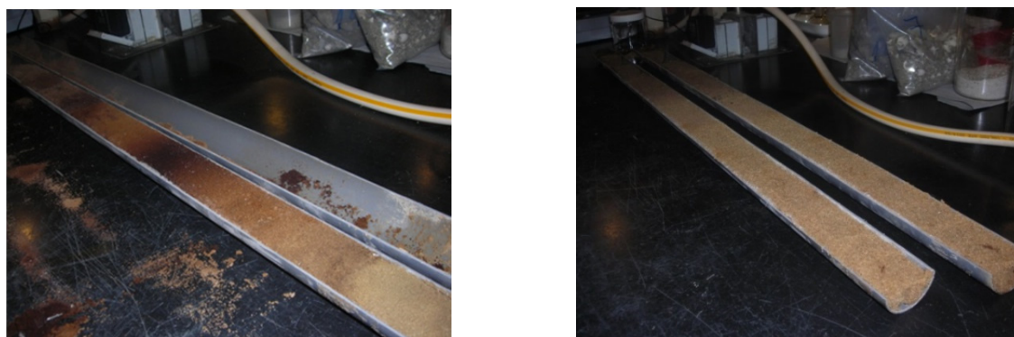
Figura 6.4- Perfis de material amostrado. Os perfis foram subdivididos em seis secções com 30 cm de comprimento para determinações dos parâmetros seleccionados e para análises químicas.
