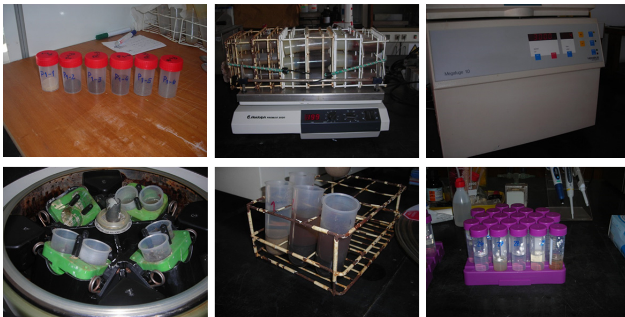
Figura 6.8- Vários aspectos da preparação das amostras para as determinações químicas de aniões principais por cromatografia iónica. Da esquerda para a direita e de cima para baixo: sedimentos correspondentes às seis secções de um perfil; agitação das soluções a 200 vibrações/minuto; centrifugação das amostras a 3000 rotações/minuto; amostras na centrifugadora; soluções de solo obtidas após a centrifugação; soluções para análise de aniões por cromatografia iónica e para medição da condutividade eléctrica.
