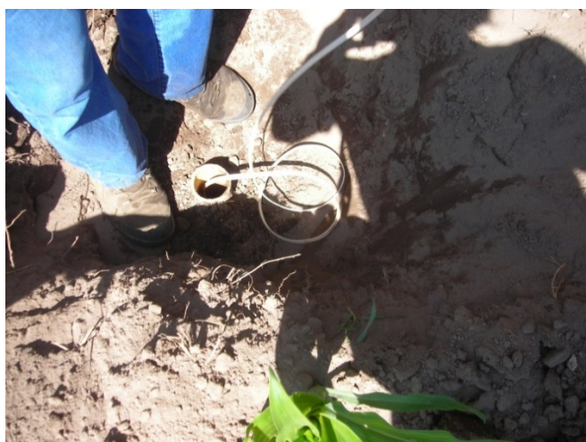
Figura 5.7- Medição da profundidade do nível de água e da captação.
