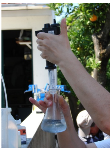
Figura 5.9- Determinação da alcalinidade por titulação colorimétrica das águas amostradas e kit HACH® utilizado nessas determinações.
