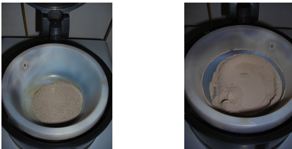
Figura 6.10- Amostra antes e depois da moagem em moinho de ágata.
