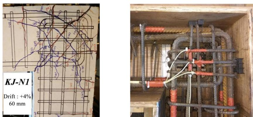
Figura 3.37 – Padrão de fissuração experimental [26] (à esquerda) e armaduras [40] (à direita)
