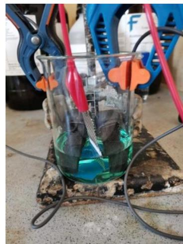
Figura 16 – Esquema e fotografia da montagem experimental realizada para as deposições num copo de 250 mL com dois blocos de grafite como eléctrodos auxiliares e o substrato como eléctrodo de trabalho.
