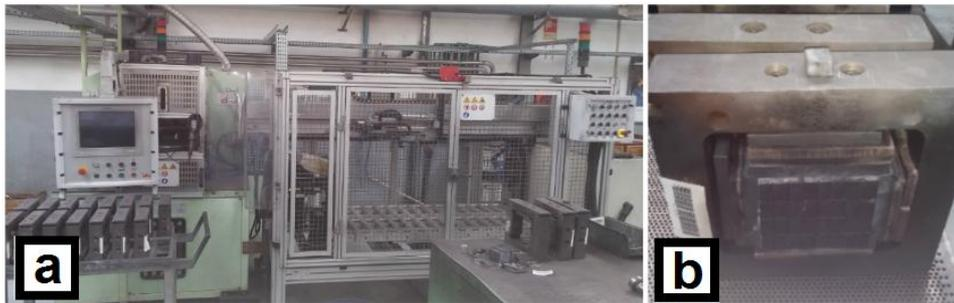
Figura 3.3 - a) Forno de prensagem a quente Idea Vulcan (DIAPOR S.A.). b) Molde de grafite com segmentos.
