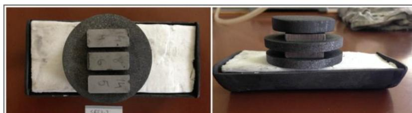
Figura 3.8 - Configuração do cadinho metálico de suporte dos segmentos, no processo de sinterização convencional.
