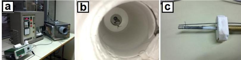
**Figura I.1 - Ensaio de avaliação do desvio da temperatura entre os termopares do Tipo-S e do Tipo-K. a) Forno eléctrico vertical *Satter SF200*; b) Vista do interior da câmara do forno; c) Termopares do Tipo-S e do Tipo-K.**
