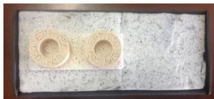
**Figura I.2 - Anéis PTCR e cadinho metálico.**
