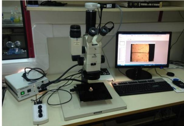
**Figura 3.17 - Microscópio Olympus SZH, com uma câmara incorporada Olympus DP20 e iluminação exterior Olympus Highlight 3100.**
