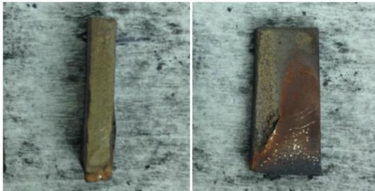
Figura 4.3 - Segmento deformado devido à formação de fase líquida em excesso. Condições do ciclo térmico: 922°C/5min.
