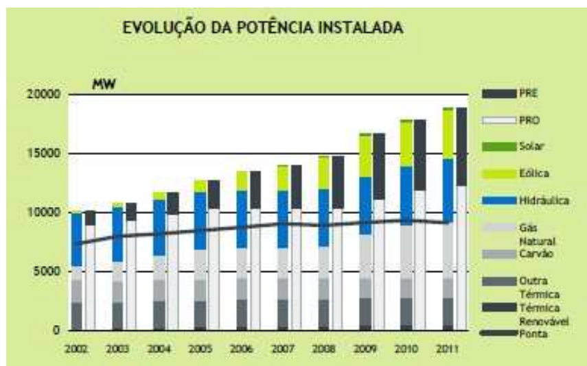
Figura 22 – Cobertura da ponta pela potência instalada
