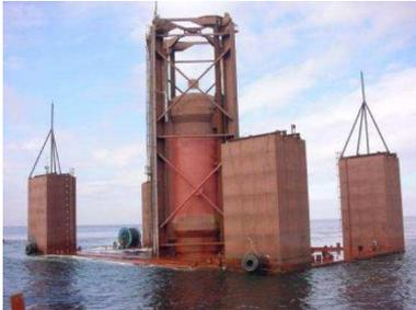
**Figura 1.2 Dispositivo em fase de imersão (Archimedes Wave Swing)**
