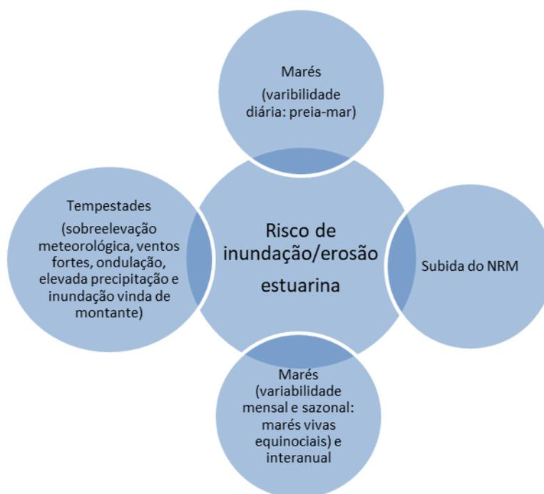
**Fig. 26:** Fatores que podem desencadear eventos extremos, quando conjugados, aumentando o risco de inundação e erosão estuarina, adaptado de Guerreiro *et al.* (2013).
