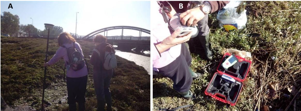
**Fig. 228:** Fotografias do levantamento (A) do limite do sapal junto à foz do Rio Judeu (Zona Sul da Baía do Seixal), feito por DGPS em modo RTK da *Leica Geosystems* (B) (2017/01/17).
