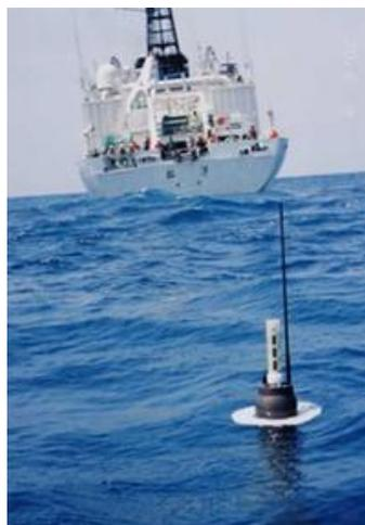
**Fig. 6 e 7:** Esquema traduzido da constituição de uma sonda do sistema Argo. O seu comprimento é de cerca de 2 m e fotografia de uma sonda a flutuar; in <http://www.inctambtropic.org/grupos-de-trabalho/oceano/interacao-oceano-atmosfera.html>
