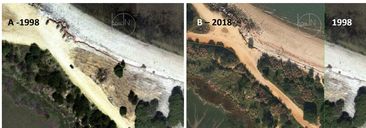
**Fig. 86:** A - Ortofotomapa de 1998 com traçado de linha vermelha correspondente ao talude de erosão e base da duna. B - Sobreposição do ortofotomapa de 2018 ao de 1998, permitindo ver o recuo de cerca de 4 m em 20 anos.
