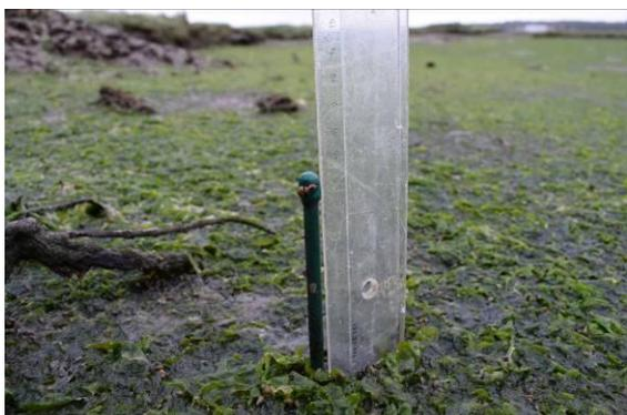
**Fig. 256:** Na estaca de ferro do sapal de Corroios houve muito baixa sedimentação, de 1 mm decorridos em 4 anos, o que pode ser devido à redistribuição dos sedimentos do talude em erosão (16-04-2019).
