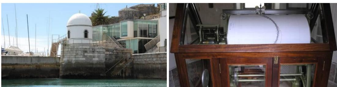
**Fig. 12:** O Marégrafo de Cascais analógico, cujo sistema foi construído em 1877 por A. Borrel, em Paris, e encontra-se ainda em pleno funcionamento. Ligado ao laboratório oceanográfico do rei D.ra-Carlos I, o primeiro Marégrafo de Cascais foi instalado em 1882 na rocha, a Este da fortaleza, sobre a baía de Cascais, tendo mudado para o sítio atual (deslocação de ~30 m) em 1900 *in* <http://www.cm-cascais.pt/equipamento/maregrafo-de-cascais>
