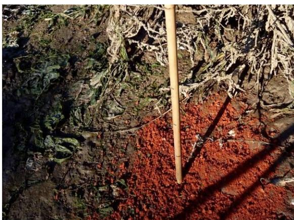
**Fig. 236:** Estaca de bambu com marcações de 5 em 5 cm, colocada em Março de 2015, com pó de tijolo, junto à Ponte da Fraternidade (Foz do Rio Judeu).
