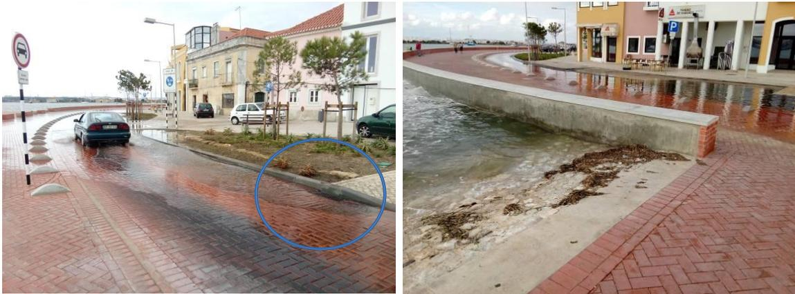
**Fig. 198 e 199** : Fotografias tiradas em Outubro de 2018, também numa maré viva e preia-mar. Note-se que o pavimento está seco (não havia temporal/ondulação), e a entrada de água deu-se pelo sumidouro existente (círculo azul).
